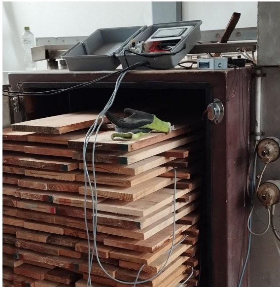
Figura 2: Horno de secado de madera marca Hildebrand.
