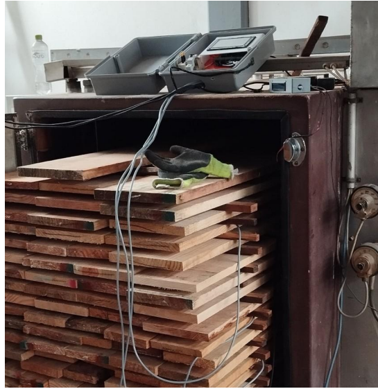
Figura 16: Colocación de los sensores SHT22 y PT100 en la madera a secar dentro del horno de secado
