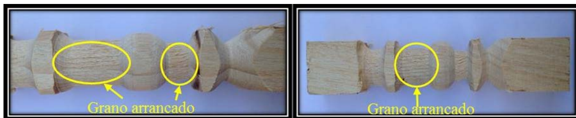
Figura 56. Grano arrancado, defecto más frecuente en el torneado al 10% y 15% de contenido de humedad.
