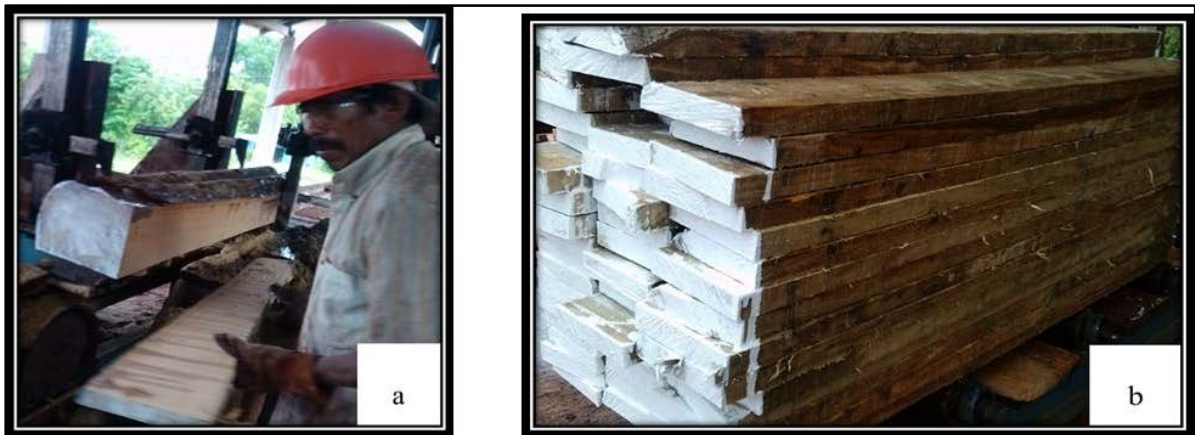
Figura 7. Aserrío de las trozas: a) Obtención de tablas-patrón y aplicación de la plantilla “Plain sawn”; b) Sellado de las tablas-patrón.
