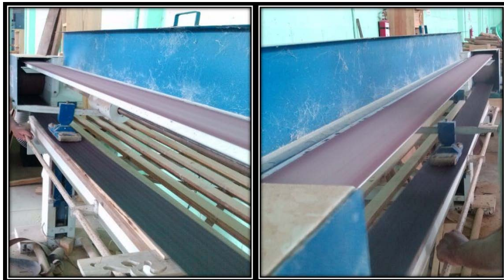
Figura 14. Lijadora de banda invicta modelo delta adaptado con salida de aserrín.
