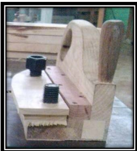
Figura 18. Implemento de sujeción de probetas del moldurado.
