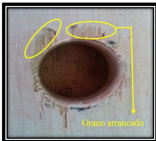
Figura 38. Grano arrancado, defecto más frecuente en el taladrado al contenido de humedad del 10%.
