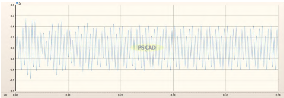
Figura 5.2: Caso 1: Voltaje de la fuente en PSCAD
