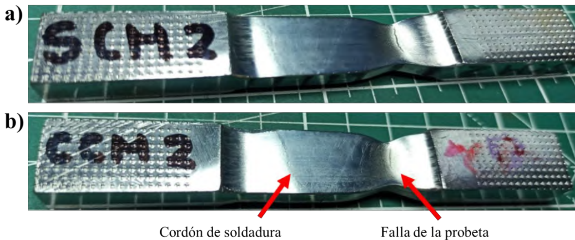
Figura 4.22. Probetas de tensión con microestructura revelada. a) SCM y b) CCM.
