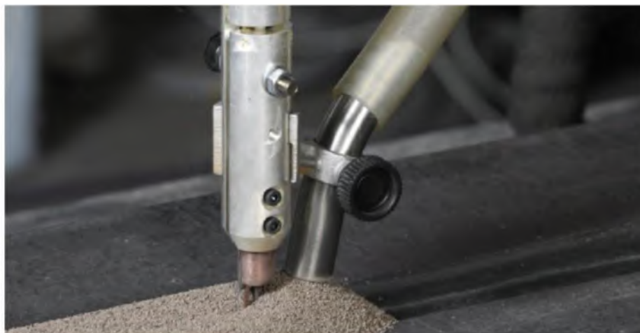
Figura 2.1. Proceso de la soldadura por arco sumergido [28].
