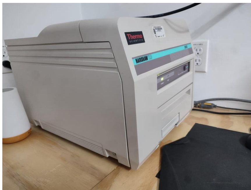
Figura 3.2 Harshaw TLD 3500, Equipo usado para medir la radiación absorbida por un material termoluminiscente o dosimétrico.
