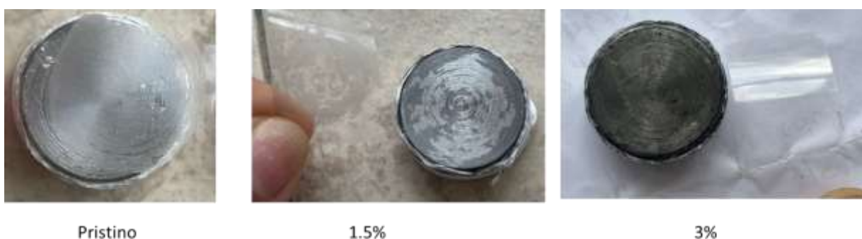
Figura 28 Imagen de las pruebas de corte por enrejado en el acero A572 recubierto
