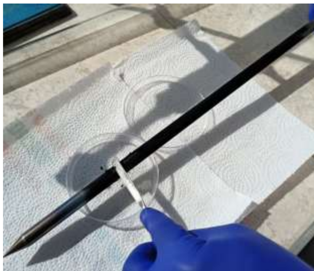
Figura 15 Imagen de recolección de nanotubos obtenidos
