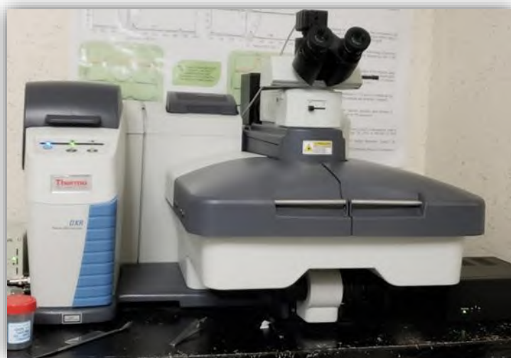
Figura 27. Equipo Raman Thermo Scientific DXR.
