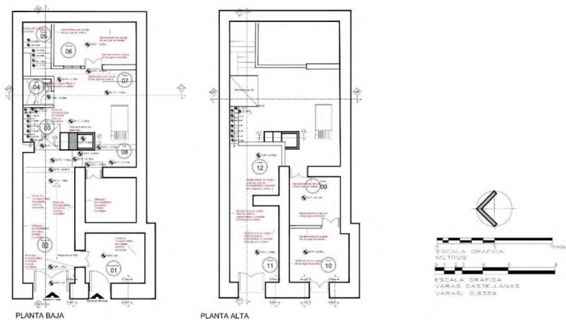
Ilustración 94 Planta arquitectónica con las grietas que tiene la edificación y el desplome en la fachada. Proyecto: KXFC.
