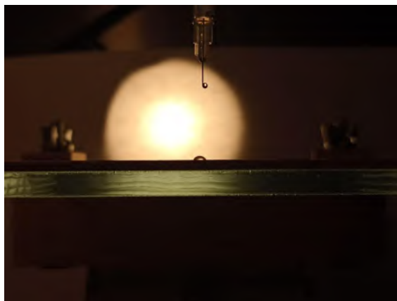
Figura 3.3: Medición de ángulo de contacto sobre muestra de Picea abies con ayuda de un goniómetro.
