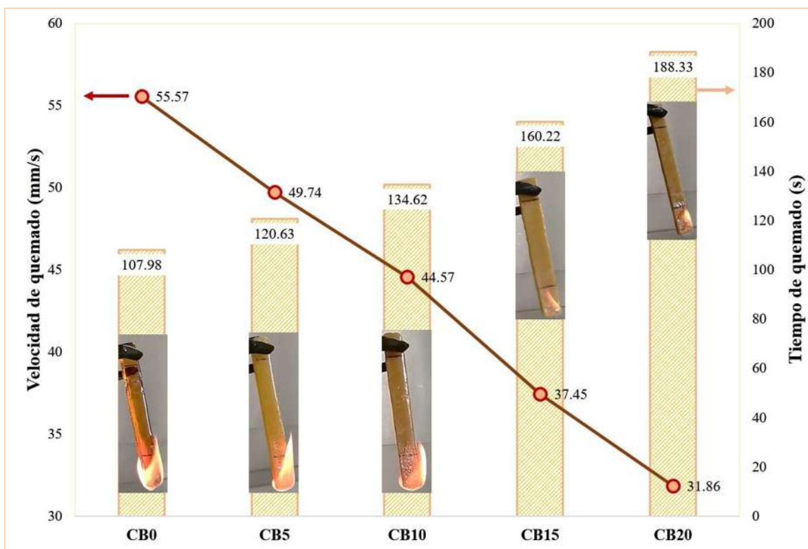
Figura 34. Resistencia a la flama de CB0-CB20.
