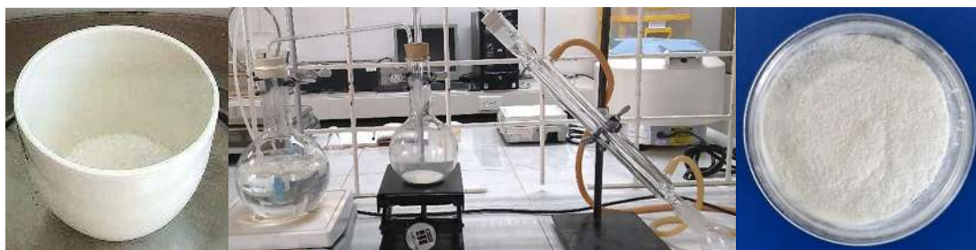
Figura 9. Proceso de hidroxilación de biosílice.
