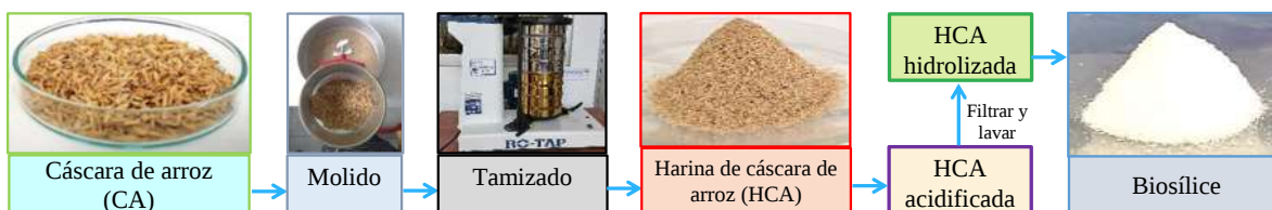
Figura 8. Proceso de obtención de biosílice a partir de cáscara de arroz.
