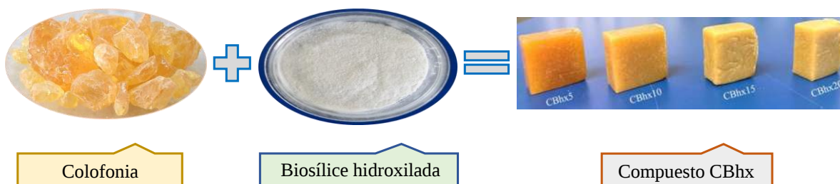
Figura 14. Material compuesto a partir de colofonia-biosílice hidroxilada.
