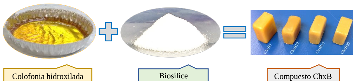
Figura 13. Material compuesto a partir de colofonia hidroxilada-biosílice.
