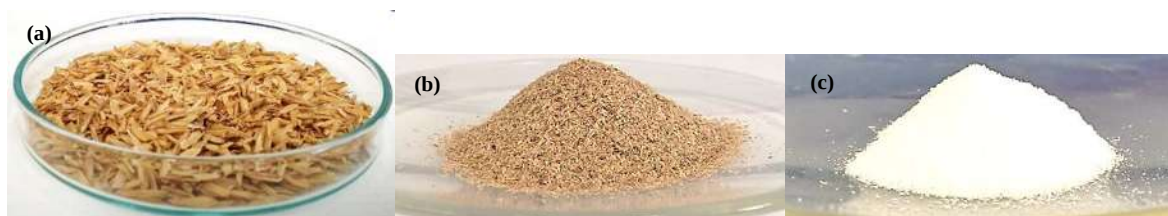
Figura 16. Comparación de los tres materiales CA (a), HCA (b) y biosílice (c).
