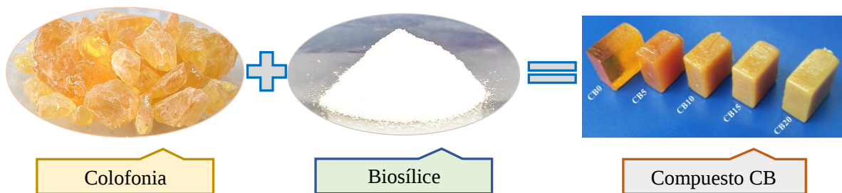
Figura 12. Material compuesto a partir de colofonia-biosílice.
