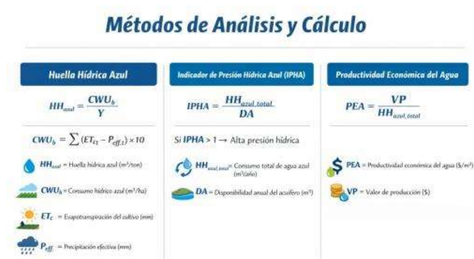
Figura 1.3.6. Procedimientos para la evaluación y el cálculo de la huella hídrica azul, el indicador de presión hídrica azul (IPHA) y la productividad económica del agua.
