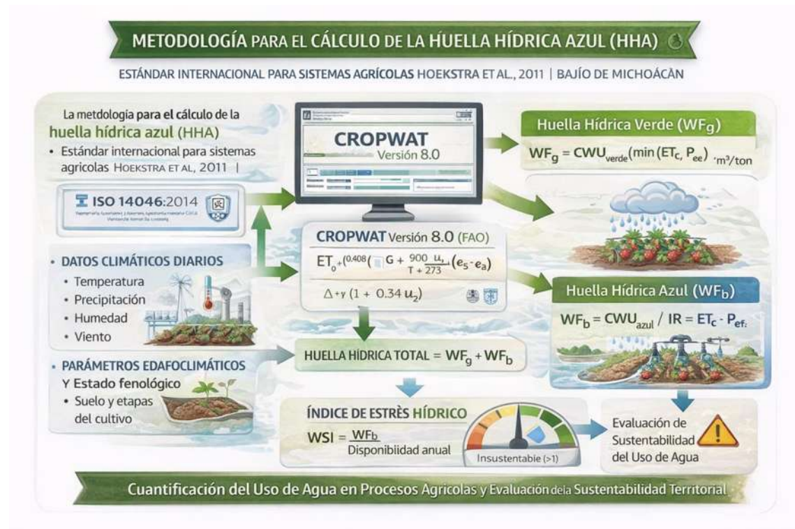
Figura 2.3.4.1. Metodología para el cálculo de la huella hídrica azul (HHA) en sistemas agrícolas basada en el enfoque de Hoekstra et al. (2011)
