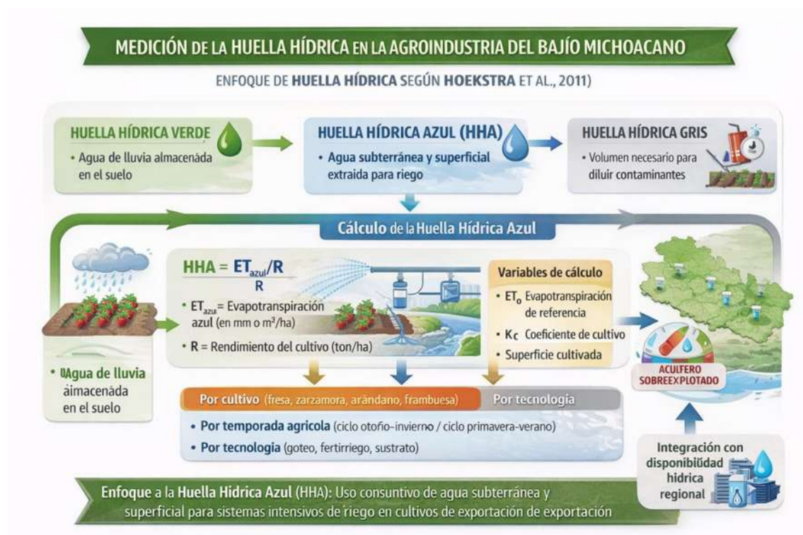
Figura 2.3.3. Esquema metodológico para la medición de la huella hídrica en la agroindustria del Bajío michoacano con base en el enfoque de Hoekstra et al. (2011)
