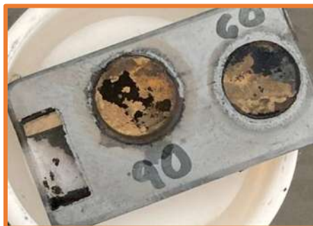
Figura 8.12. Síntesis a 150^\circ\text{C} por 24 h y 6mmol \text{Ag}_2\text{S}
