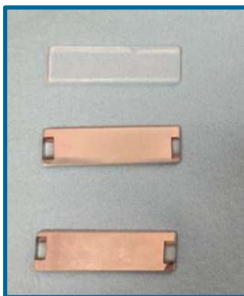
Figura 8.3. Recubrimiento de Titanio metálico sobre soporte de vidrio de 200 a 500 nm.
