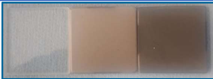
Figura 8.8. Etapas de síntesis de película de \text{TiO}_2
