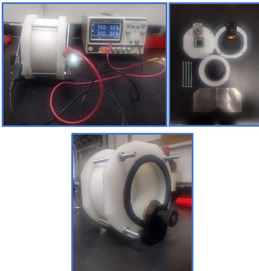
Figura 8.7. Nuevo reactor de anodizado para generar áreas de 30 \times 30 \text{ mm}^2 de nanotubos
