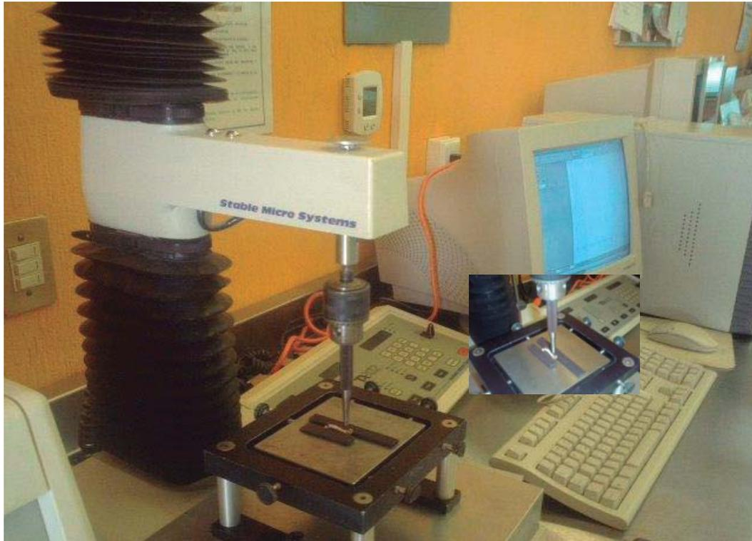
**Figura 4. Medición de compresión con el Texturómetro TA-XT2 en los fémures de los animales alimentados con las dietas experimentales.**
