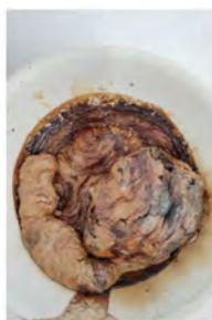
Figure 3.13: Xerogels obtenidos para el compuesto Sr_2NiWO_6 con sus distintos pH.
