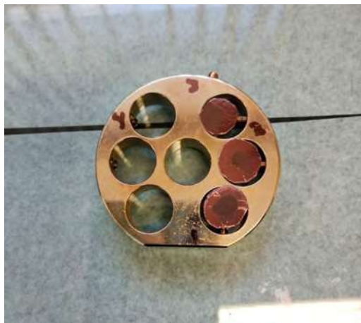
Figure 4.5: Portamuestras con el compuesto Sr_2CoWO_6 recubierto de oro.
