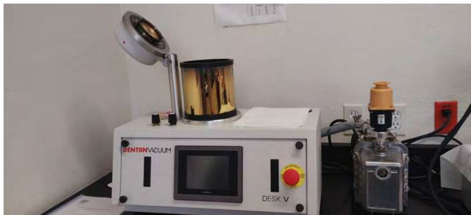
Figure 4.6: Equipo de pulverización catódica del laboratorio de microscopía de la ENES UNAM Unidad Morelia.
