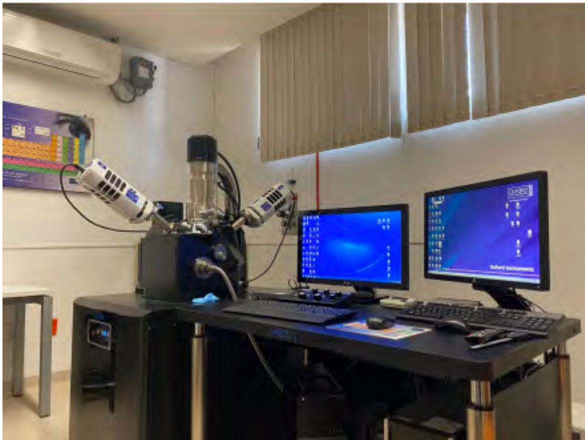
Figure 4.7: Equipo de microscopio de barrido electrónico JEOL JSM-IT300, actualmente se encuentra en el laboratorio de Microscopía de la ENES Campus Morelia.
