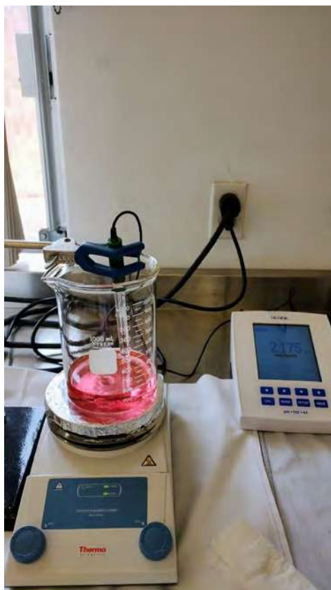
Figure 3.6: Arreglo implementado con potenciómetro para medir el pH de acuerdo a cantidad de hidróxido de amonio ( NH_4OH ) agregado a la “solución maestra”.
