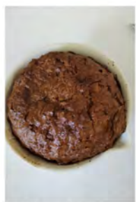
Figure 3.13: Xerogels obtenidos para el compuesto Sr_2NiWO_6 con sus distintos pH.
