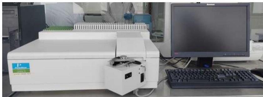
Figura 3.7. Equipo de UV-Vis utilizado para identificar los complejos metálicos formados de las reacciones metal-cianuro en las soluciones unitarias.
