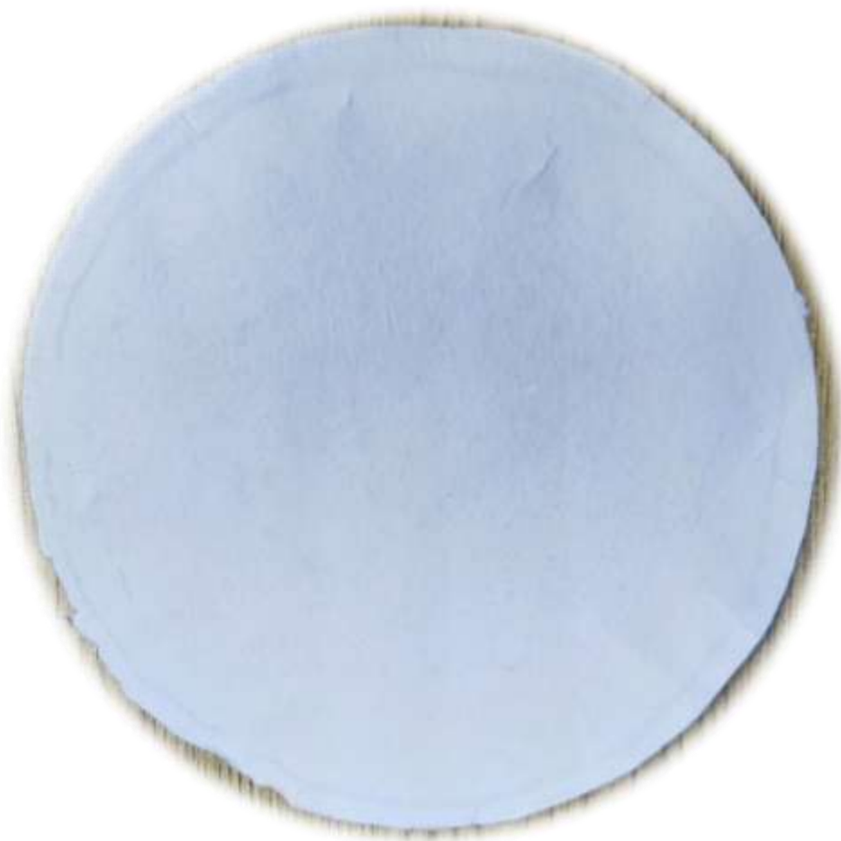
Figura 27. Hoja Tappi generada a partir de pulpas celulósicas del endocarpio para la medición de blancura y opacidad.
