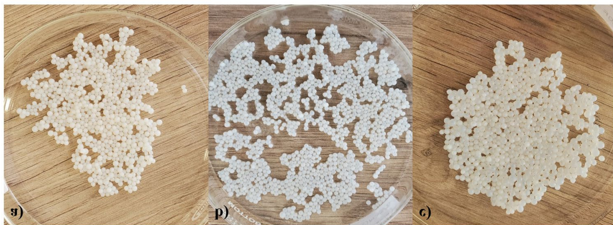
Figura 3.4 Microesferas obtenidas mediante gelación iónica. a) CS8/CMC2/MMT6, b) CS7/CMC3/MMT33 y c) CS8/CMC2/MMT50.
