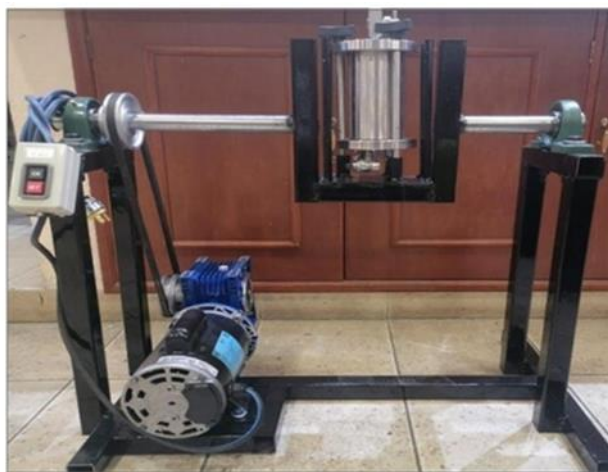
Figura 3.2 Extractor comercial modelo ZHE1000 de acero inoxidable 316 utilizado para los ensayos de lixiviación según el método EPA TCLP 1311.
