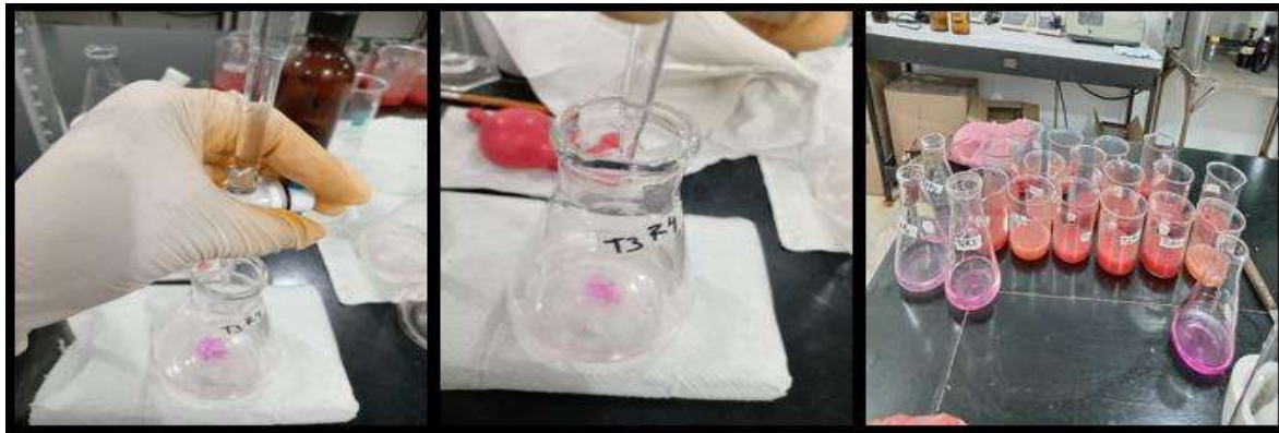
Figura 3.18. Medición por titulación para medir la acidez de los jitomates.
