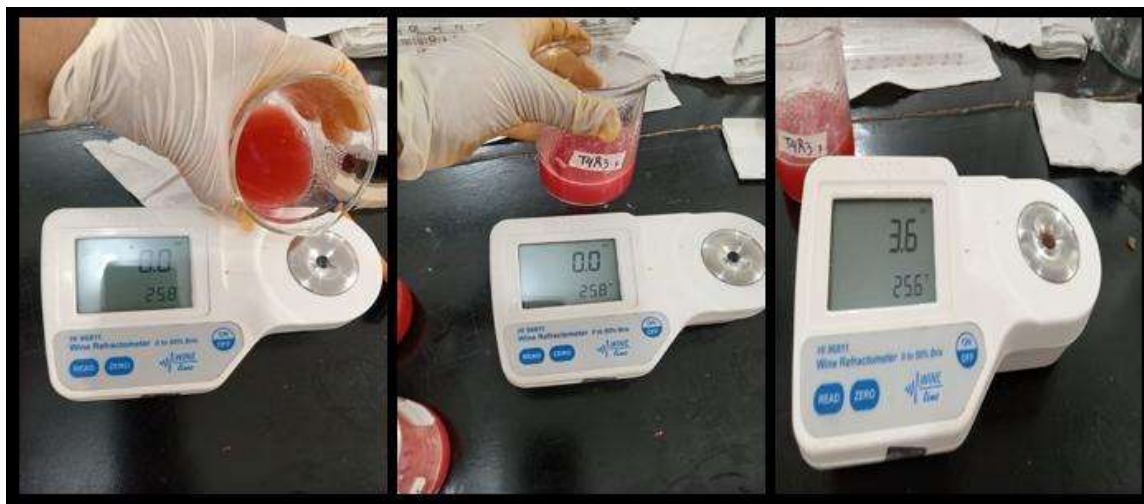
Figura 3.16. Medición de sólidos solubles en jugo de jitomate con un refractómetro.
