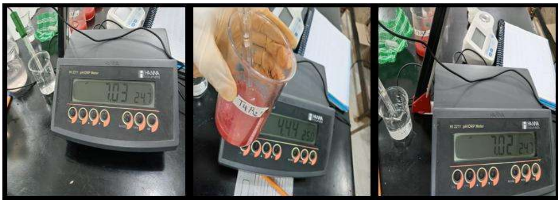
Figura 3.17. Medición del pH del jugo de jitomate con un potenciométrico.
