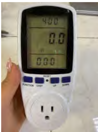
Figura 8.12. Medidor digital de consumo eléctrico
