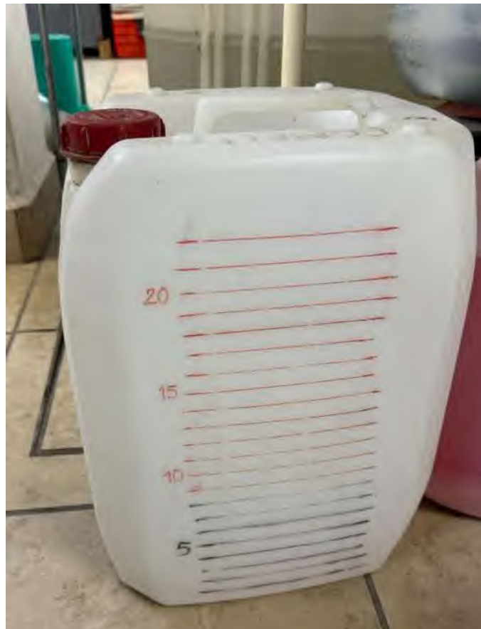
Figura 9.3 Tanque del desplazamiento del líquido.
