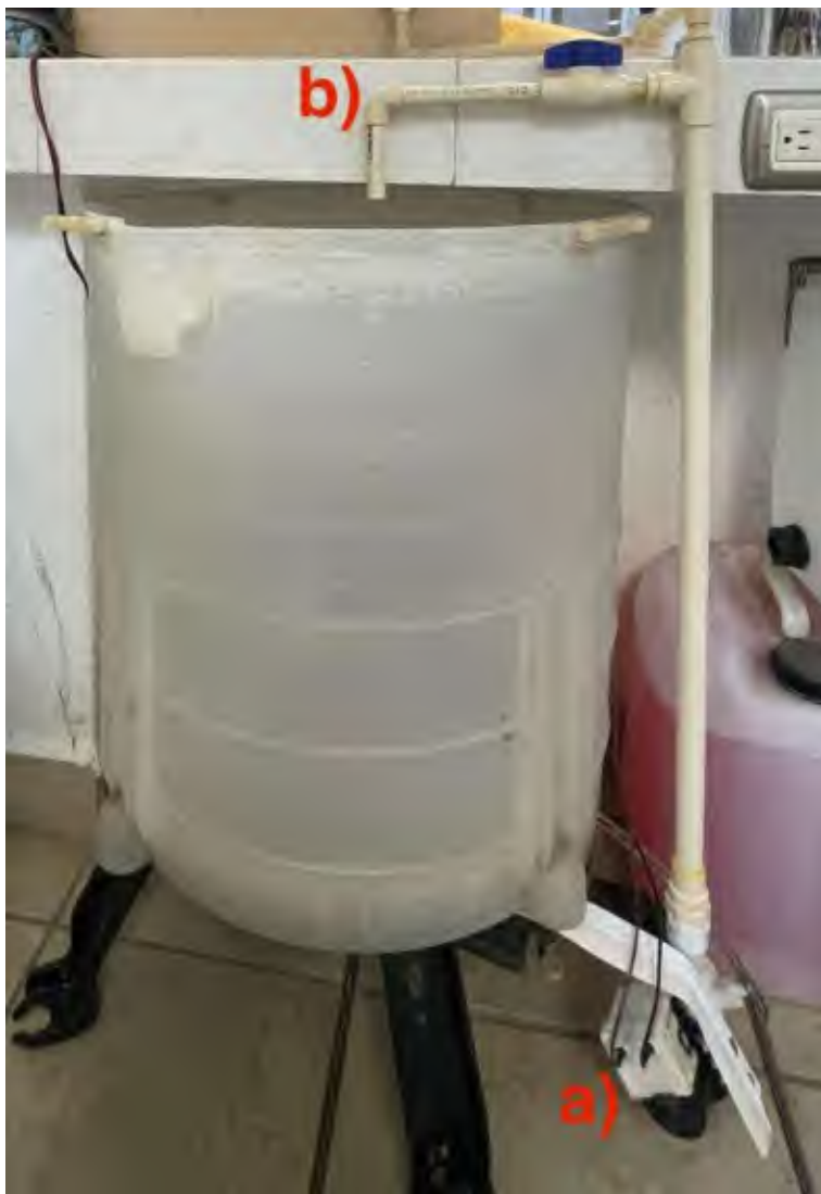
Figura 9.4 Tanque de almacenamiento de \text{Ca}(\text{OH})_2 . a) bomba y b) recirculación del líquido.
