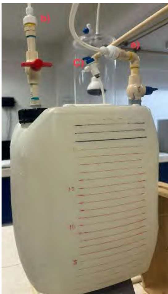
Figura 9.2 Tanque de almacenamiento de biogás tratado.
