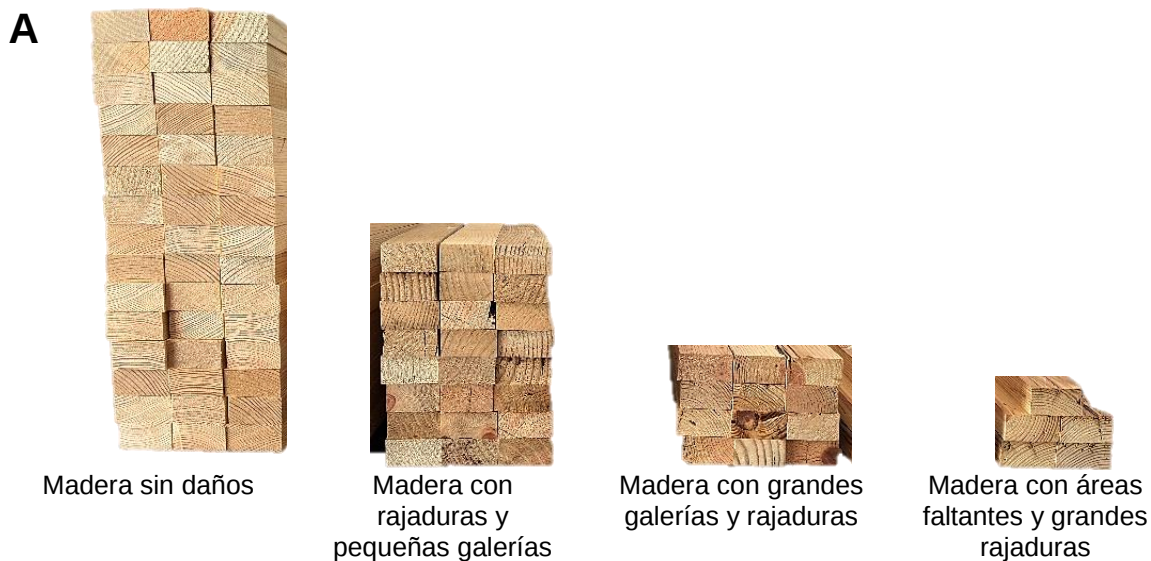
Fig. 13. Material para la elaboración de uniones; (a) Clasificación de madera sana y de recuperación.
