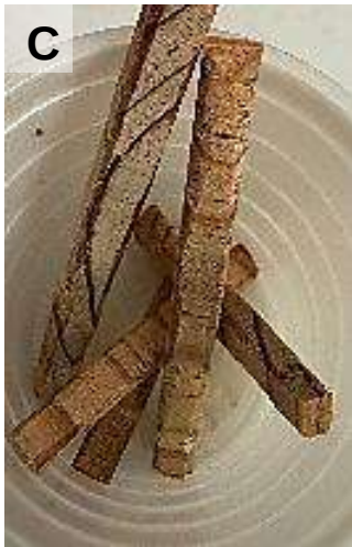
Fig. 19. Elaboración de probeta para \mu -CT; (a) corte transversal en la probeta; (b) tablillas transversales obtenidas después del corte; (c) muestras en formato cubico; (d) se utilizó un roto martillo para afinar las caras de las muestras, y estas quedaran cilíndricas; (e) muestra final para tomógrafo.
