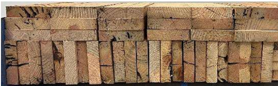
Fig. 5. Material obtenido después del maquinado de las vigas de madera de recuperación.
