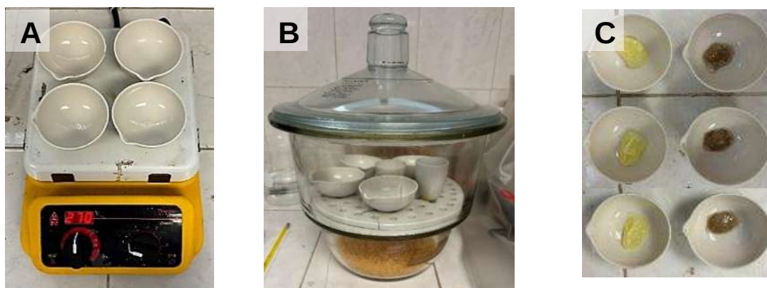
Fig. 8. Determinación de contenido de sólidos; (a) tarado de crisoles; (b) desecado de muestras; (c) sólidos restantes.
