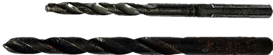
Fig. 16. Detalle de brocas para elaboración de perforaciones.
