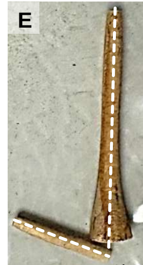
Fig. 19. Elaboración de probeta para \mu -CT; (a) corte transversal en la probeta; (b) tablillas transversales obtenidas después del corte; (c) muestras en formato cubico; (d) se utilizó un roto martillo para afinar las caras de las muestras, y estas quedaran cilíndricas; (e) muestra final para tomógrafo.
