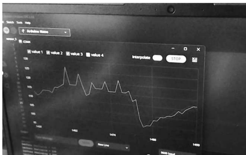
Figura 75. Cambio de la resistencia eléctrica en una muestra con 5% de grafito, debido a la deformación de esta.
