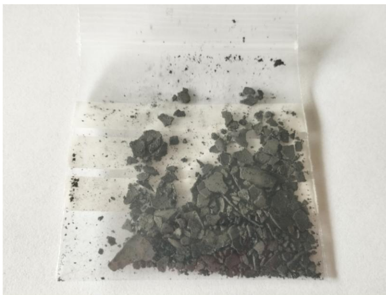
Figura 48. Compósito de almidón de arroz y 5% de grafito, fracturado debido a una deficiente adhesión entre sí.
