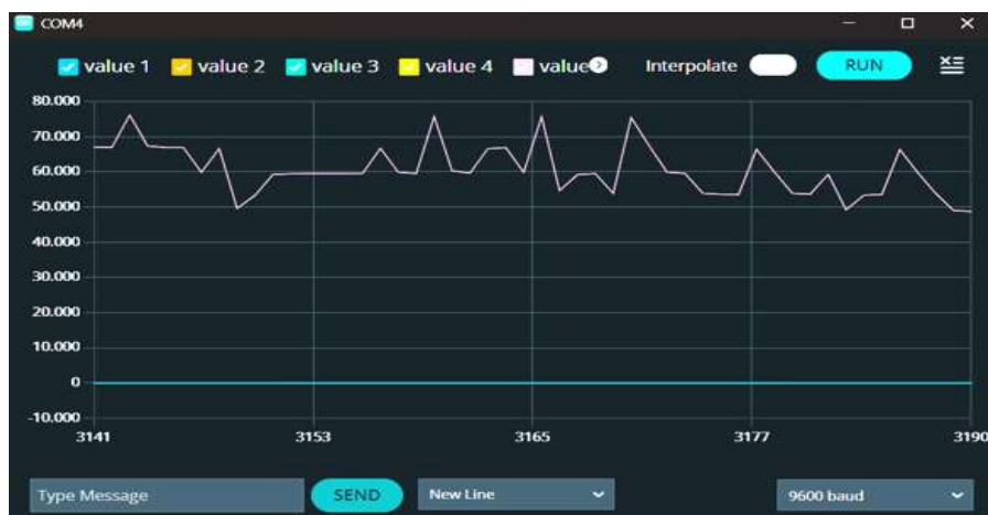
Figura 74. Grafica de las primeras pruebas de resistencia eléctrica con Arduino y dos conexiones.
