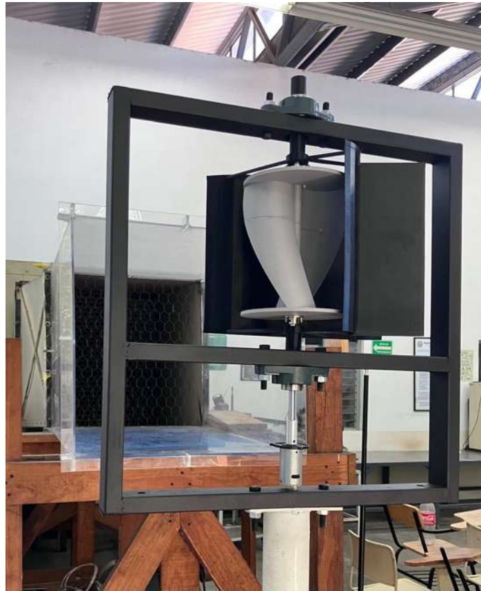
Figura 45: Estructura Base para Montaje de Rotor
