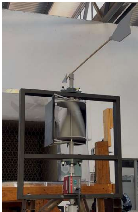
Figura 53: Veleta en Funcionamiento con Inductor.
