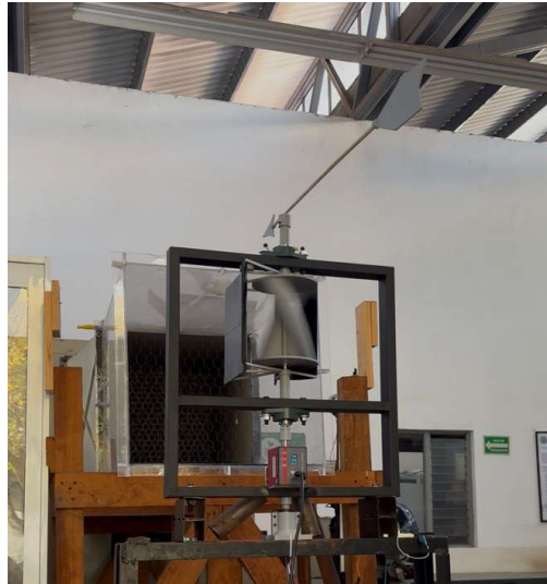
Figura 60: Montaje de Pruebas Experimentales con Inductor.
