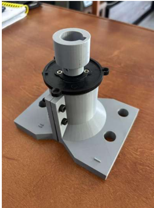
Figura 47: Soporte y Acoplamiento de Generador.
