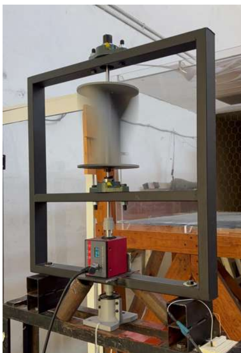
Figura 57: Montaje de Pruebas Experimentales sin Inductor.
