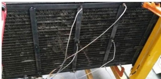
Figura 4.1 Radiador en banco de pruebas. Fuente: Elaboración propia.
