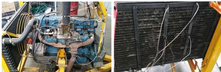
Figura. 4.29 Motor de combustión interna (izquierda); radiador en banco de pruebas (derecha). Fuente: Elaboración propia.
