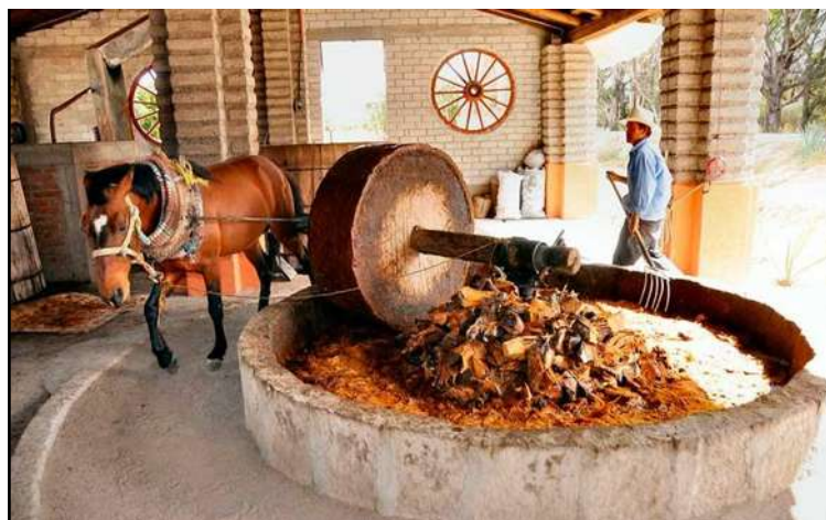
Figura 9. Proceso de molienda de las piñas del agave con tahona chilena.
