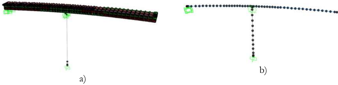
Figura B.2 Modelos analíticos: a) 3D detallado vs. b) Espina equivalente.
