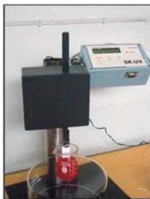
**Fig. 3.6** Integración por inmersión de las películas de celulosa
