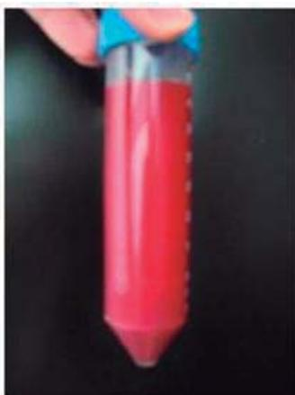
**Fig. 3.9** Integración por inmersión del AC a las nanopartículas (Nano/ACIm)
