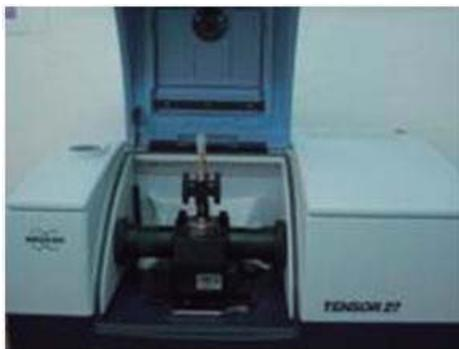
**Fig. 3.14** Espectroscopio Infrarrojo por Transformada de Fourier
