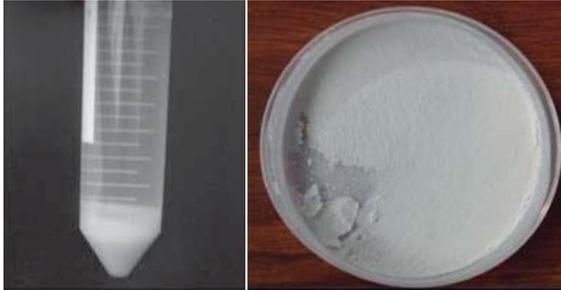
**Fig. 4.8** Nanopartículas de celulosa en solución y en seco
