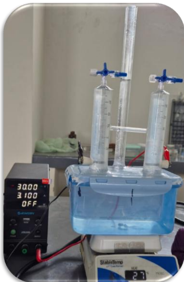
Figura 4.1. Electrolizador Tipo Hoffman modificado (modelo 1)
