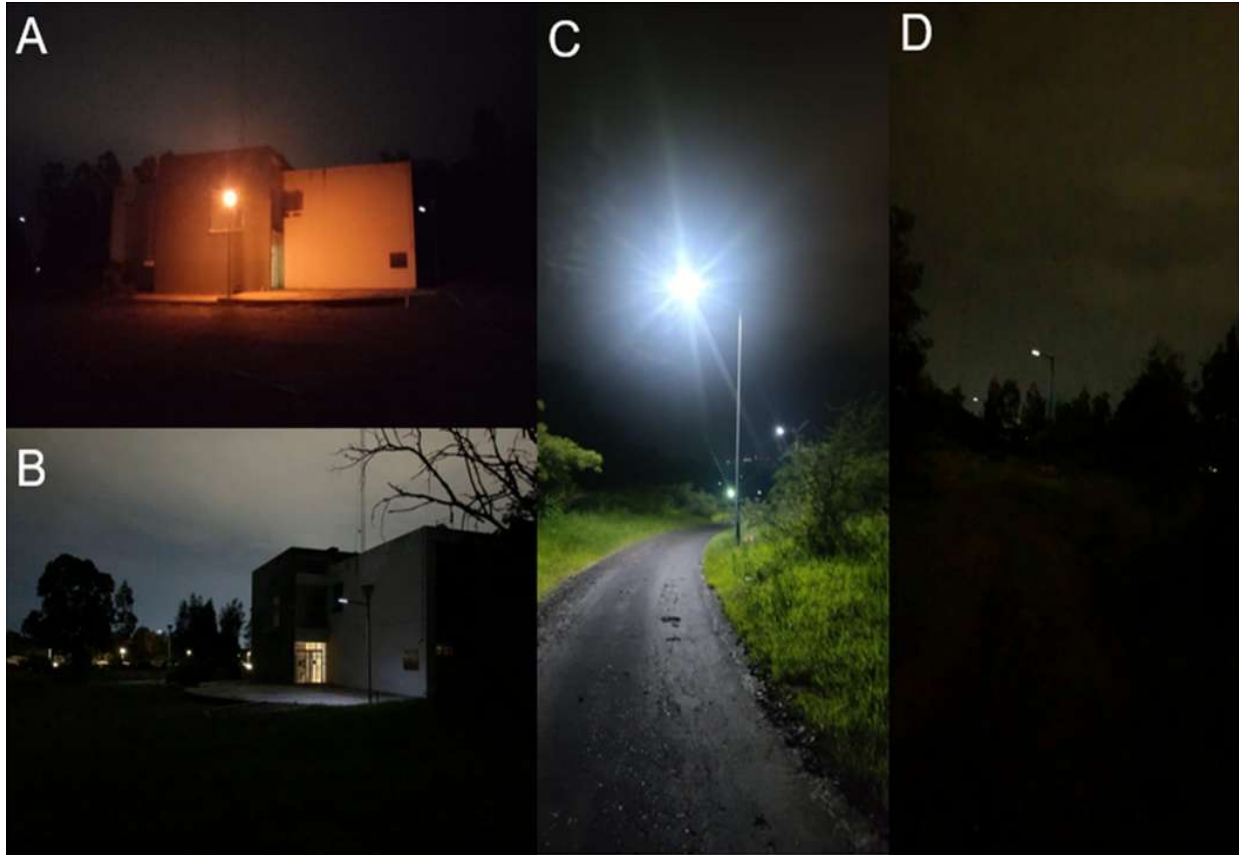
Figura 33. Modificación del alumbrado en el sitio de estudio PE-UC, sitio periurbano de conservación, Morelia, Michoacán. A) y C) Lámparas que dispersan la luz en todas las direcciones, B) y D) lámparas que reducen la contaminación lumínica. Fotos: Yesica Reyes (A y C) y Cisteil Pérez (B y D).
