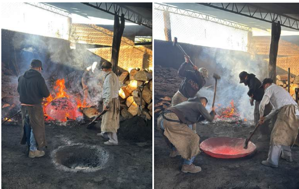
Calentado y martillado de la pieza de cobre, en proceso de elaboración de un cazo tradicional.
