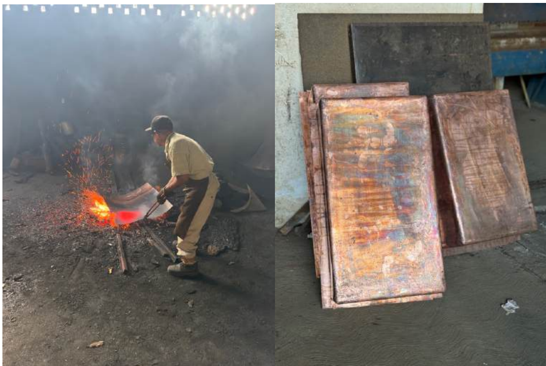
Fundición y formado de las láminas que se usarán para la creación de los productos de cobre.
