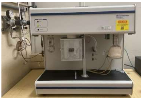
Figura 3.3. Unidad de desorción a temperatura programada de amoníaco (TPD-NH 3 ) ubicada en la Universidad del Estado de Rio de Janeiro (UERJ).
