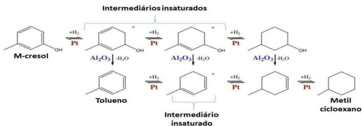
Figura 7 Mecanismo de reacción del m-cresol utilizando Pt/Al 2 O 3 (adaptado de FOSTER, 2012).
