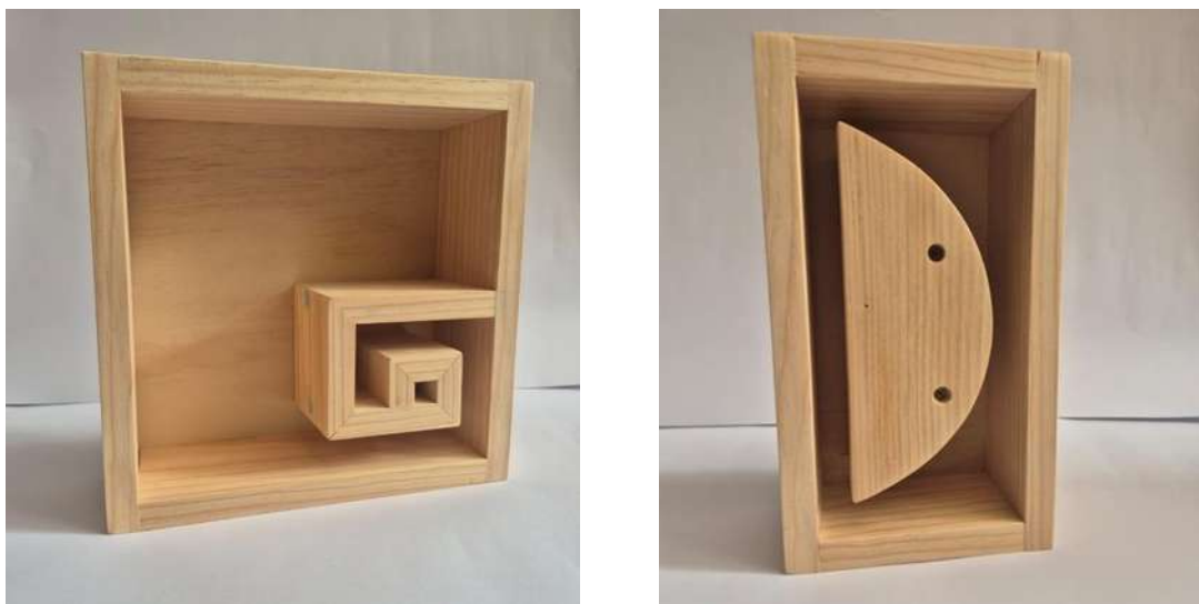
Imagen 52 Moldes cepillados y lijados, E-4 y E-6
