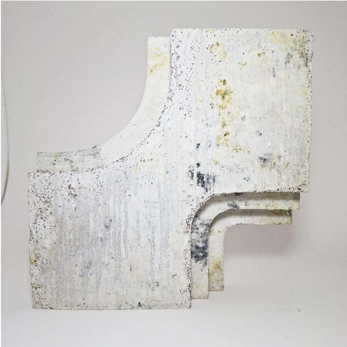
Imagen 78 Prototipo de cemento blanco con gravilla para prefabricado, con pigmentos en polvo color negro y ocre.
