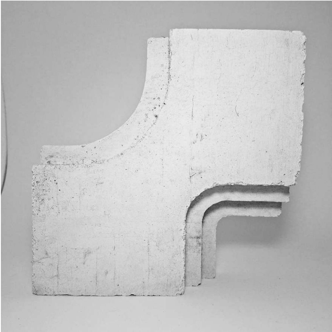
Imagen 75 Prototipo de mezcla cemento blanco con marmolina.
