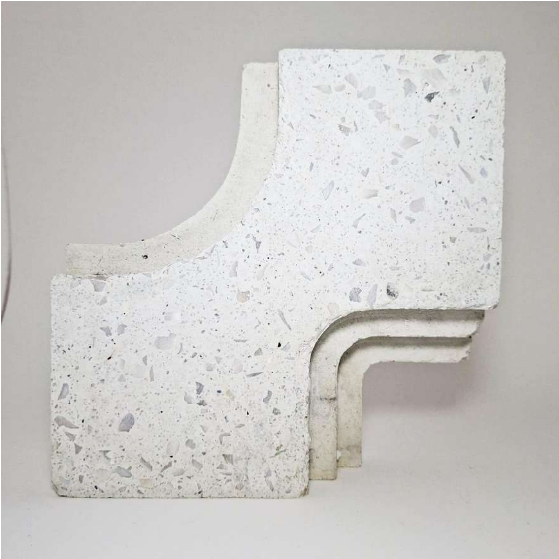
Imagen 76 Prototipo cemento blanco con mármol triturado, pulido.
