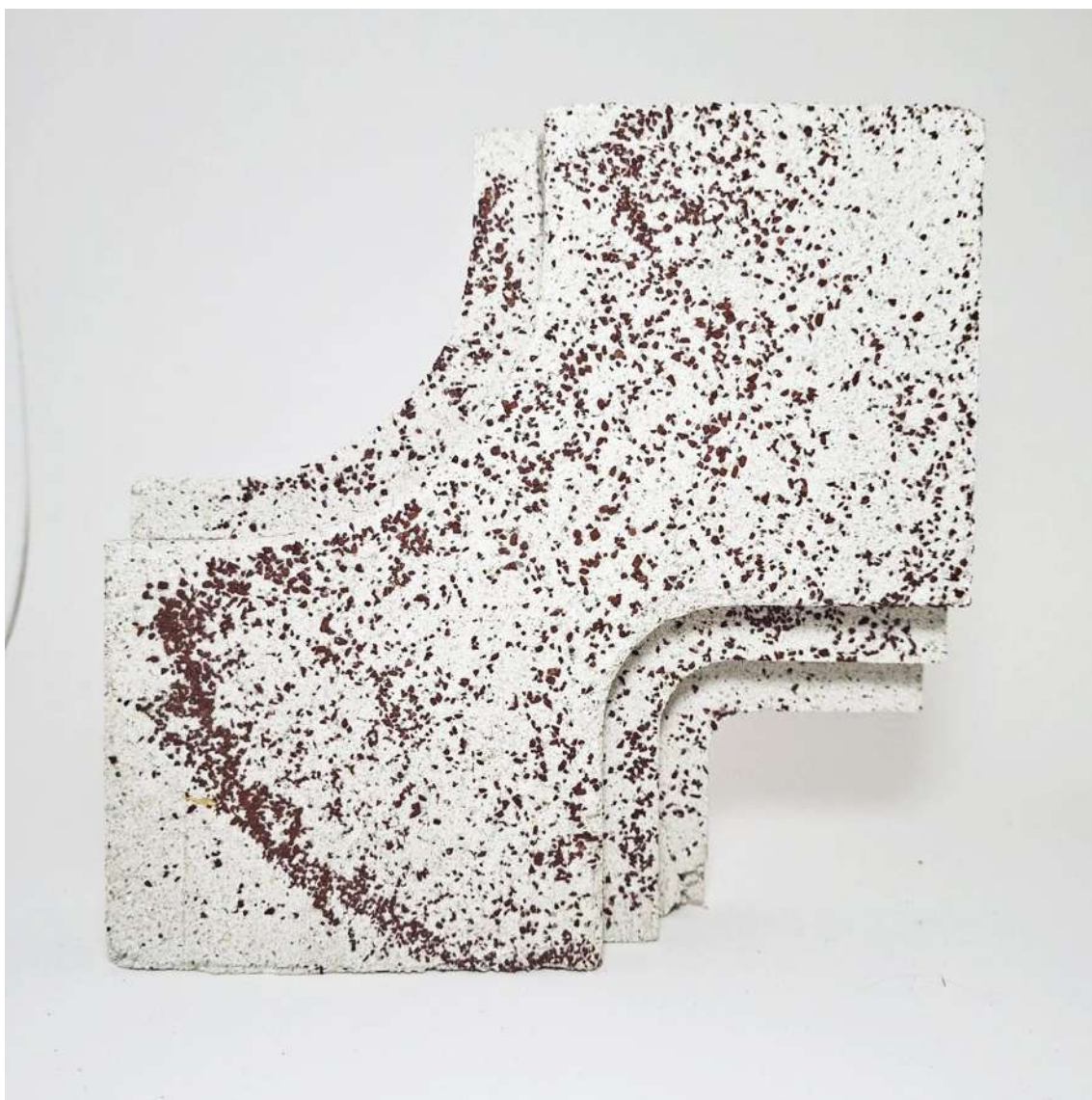
Imagen 80 Prototipo cemento blanco con marmolina y gravilla.
