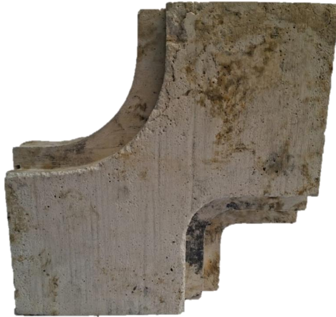
Imagen 72 Prototipo, E – 9, cemento blanco, marmolina y pigmento en polvo color negro y ocre.
