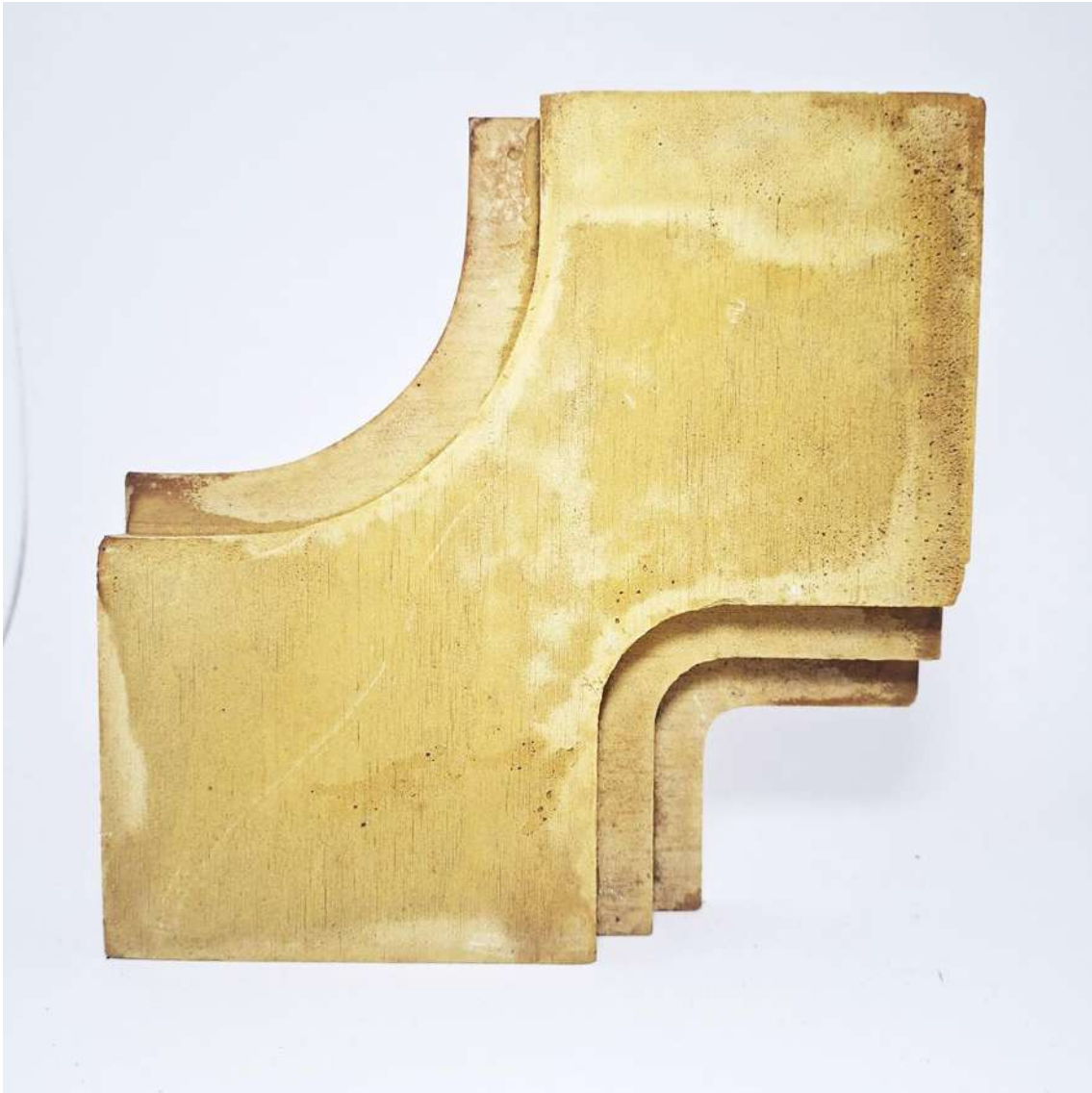
Imagen 81 Prototipo testigo de yeso, con resistol blanco y pigmento color ocre.
