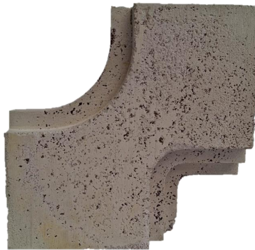
Imagen 69 Prototipo E-9, Cemento blanco con gravilla.
