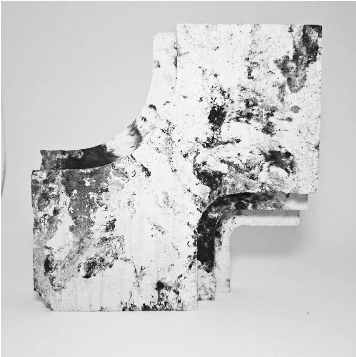
Imagen 77 Prototipo cemento blanco con marmolina y pigmento en polvo color negro.
