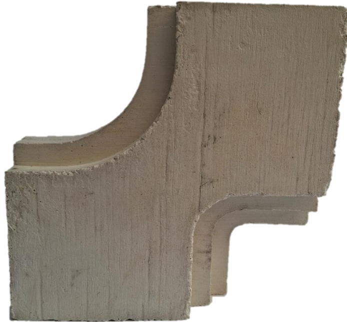
Imagen 71 Prototipo E – 9, cemento blanco y marmolina.
