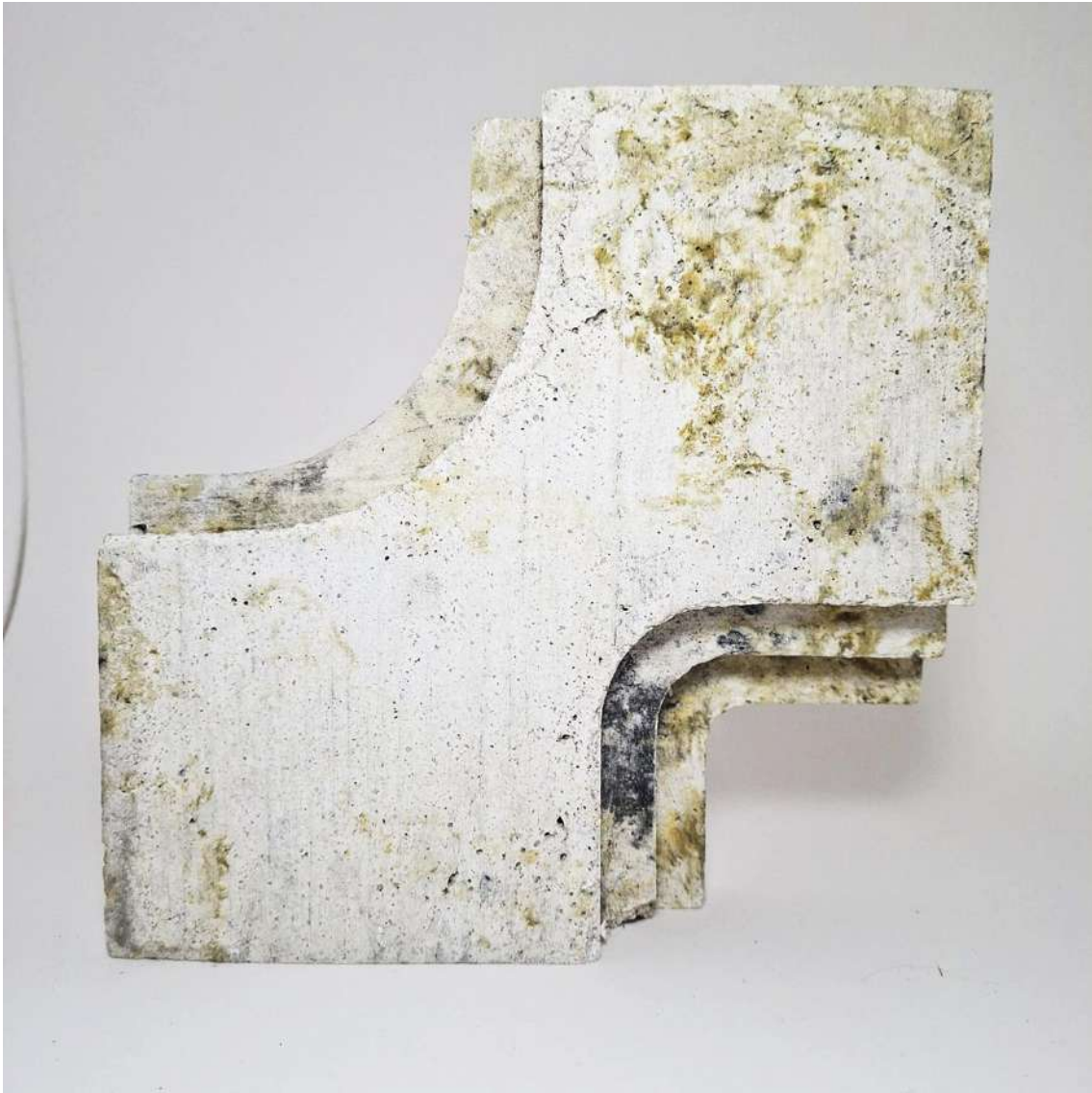
Imagen 79 Prototipo de cemento blanco y marmolina con pigmentos en polvo color negro y ocre.
