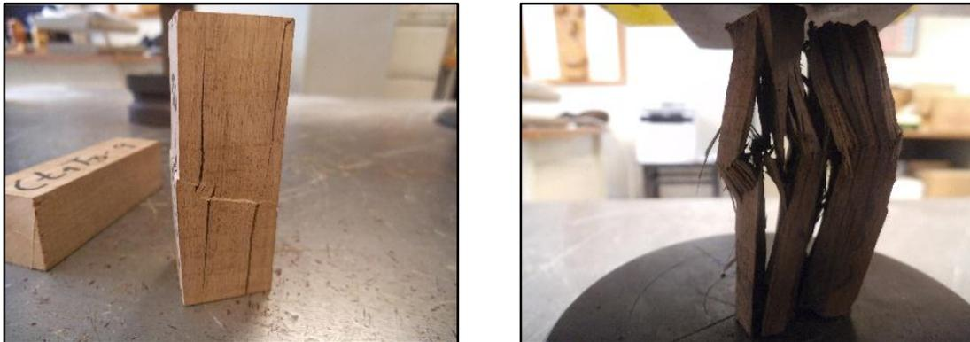
Figura 7.31. Compresión en probetas termotratadas.
