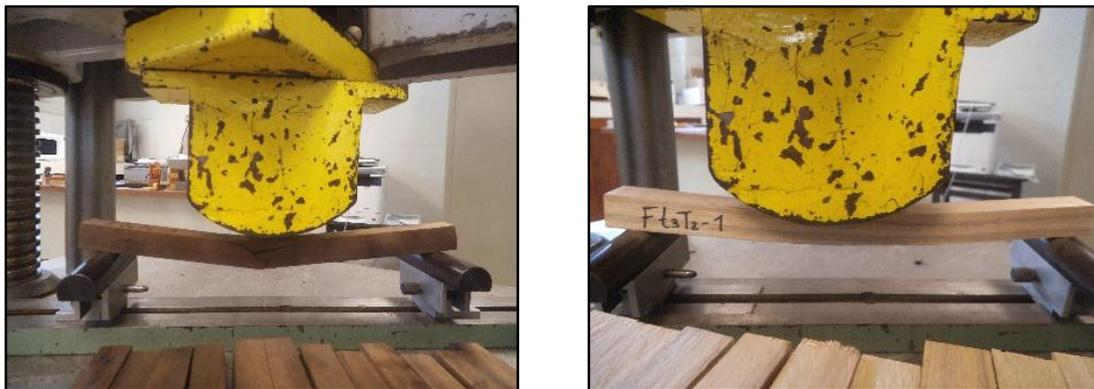
Figura 7.25. Flexión en probetas termo tratadas
