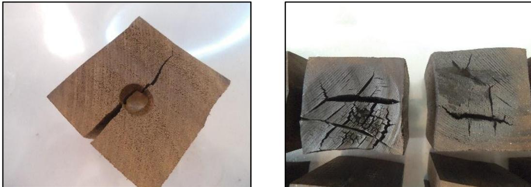
Figura 7.29. Dureza longitudinal en probetas termotratadas.
