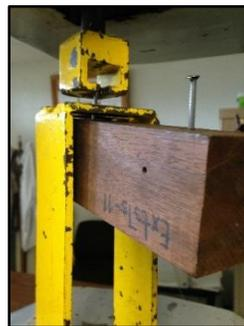
Figura 7.34. Extracción de clavos en probetas termotratadas.
