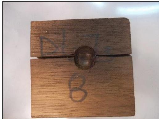
Figura 7.27. Dureza lateral en probetas termotratadas.
