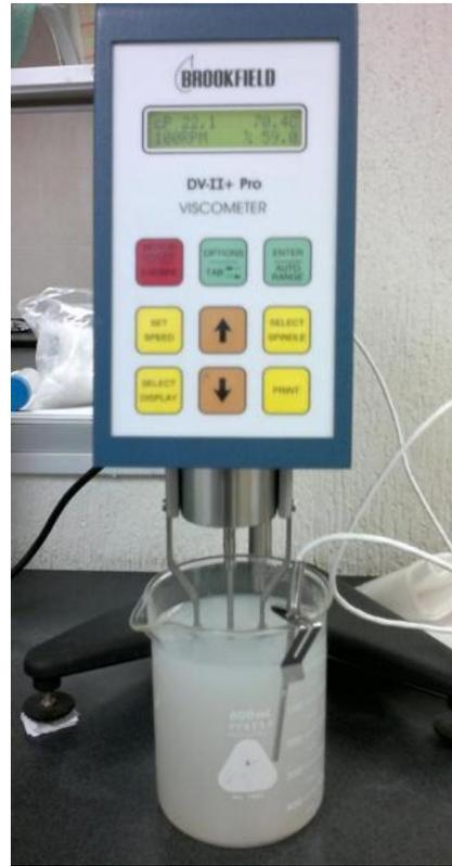
Figura 37. Medición de la viscosidad en la muestra con fécula de maíz natural en 500 ml de agua.
