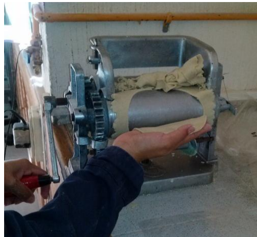
Figura 13 Máquina troqueladora para tortillas.
