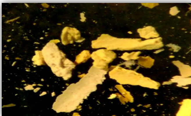
Figura 29. Micrografía del polvo obtenido por spray drying .
