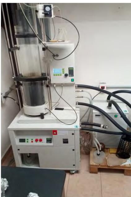
**Figura 9.** Secado del extracto acuoso en Nano spray dryer B 90.
