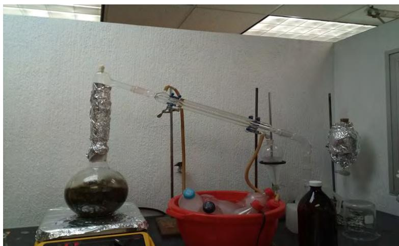
**Figura 10.** Equipo de Hidrodestilación para obtener el aceite esencial.
