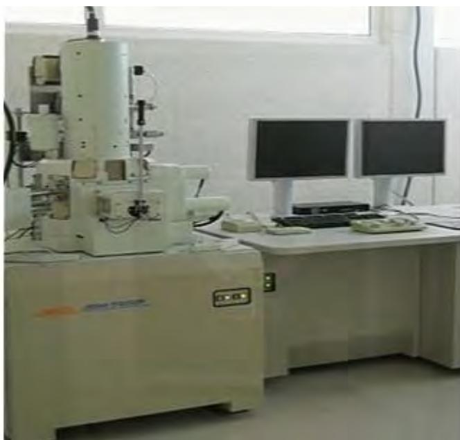
**Figura 14.** Microscopio electrónico de barrido JSM- 7600F.
