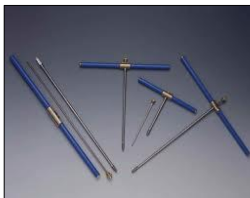
Figura 3. Taladro de Pressler.
