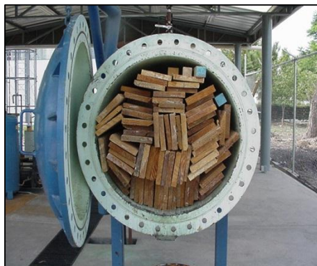
Figura 2. Autoclave para los métodos de presión y vacío.
