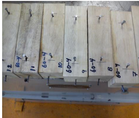
Figura 14. Probetas para determinar la resistencia a extracción de clavos.
