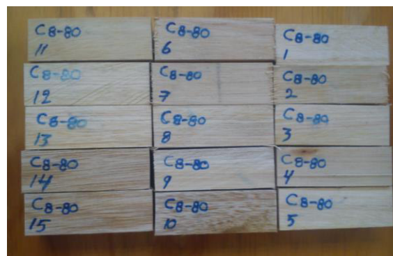
Figura 10. Probetas para determinar contracción e hinchamiento.
