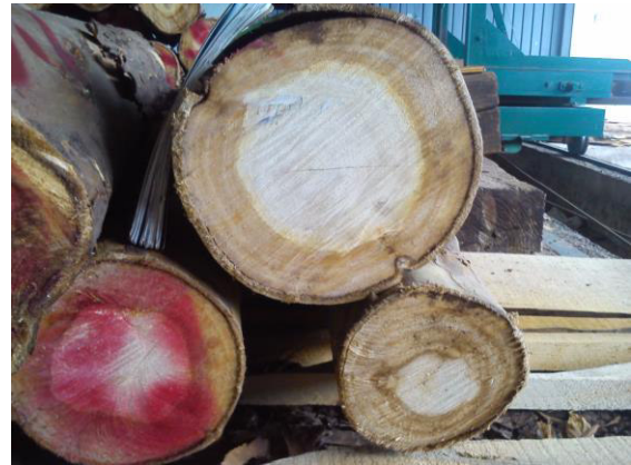
Figura 5. Sellado de los extremos de las trozas.
