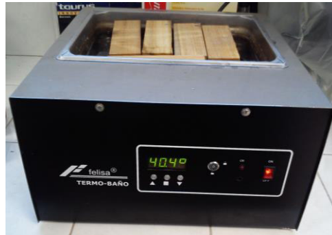
Figura 9. Inmersión de probetas en termobañó.
