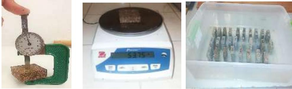
**Figura 16.** Ensayos de hinchamiento del espesor y absorción de agua.
