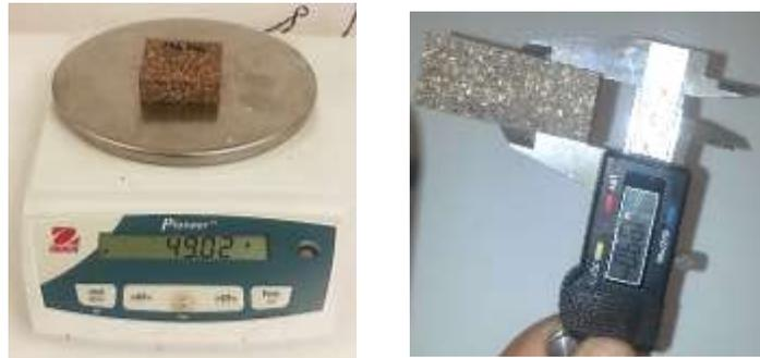
**Figura 15.** Determinación de la densidad de probetas fabricadas con partículas de *Eucalyptus nitens* y PEBD
