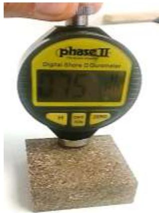
**Figura 17.** Ensayo de la dureza Shore D (HD)
