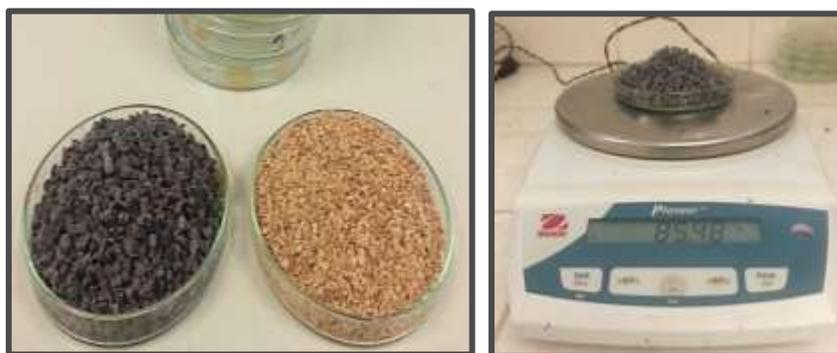
**Figura 8.** Control de las proporciones de madera y plástico
