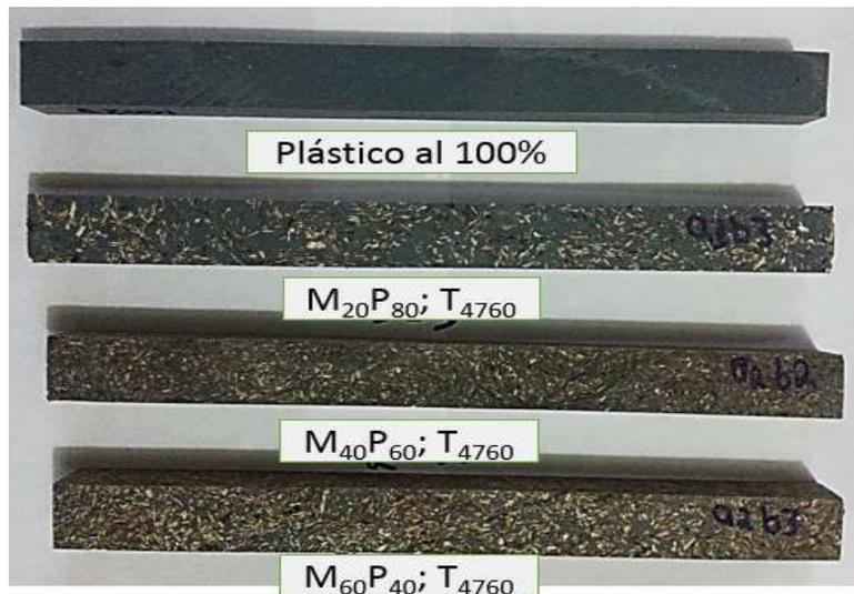
**Figura 22.** Probetas para los ensayos de flexión
