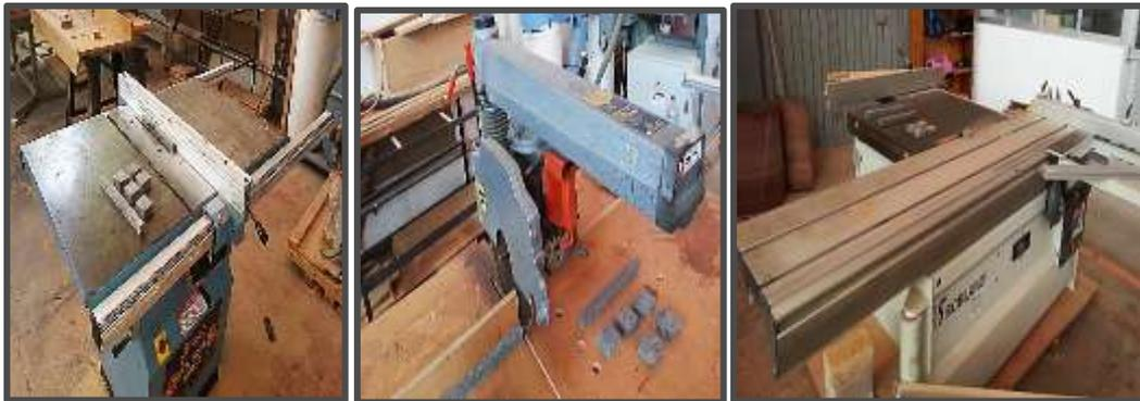
Figura 13. Maquinaria para el dimensionado de probetas
