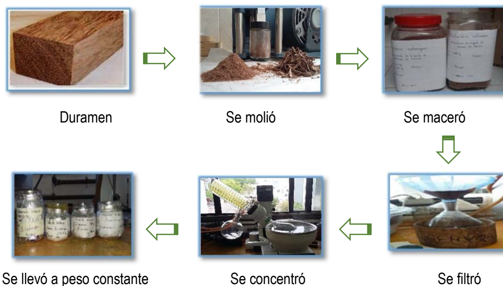
Figura 11. Proceso de obtención de extractos vegetales
