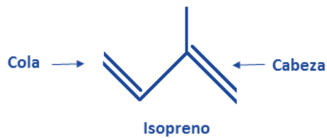
Figura 5. Estructura de la molécula de isopreno (Valencia, 1995)
