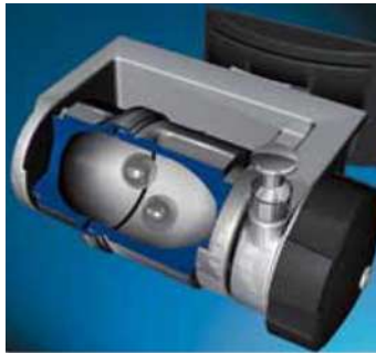
Figura A- 3: Oscilaciones en posición horizontal para las pelotas y jarras molidoras.
