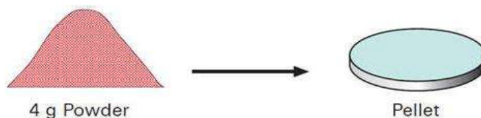
Figura A- 9: Procedimiento para hacer una pastilla sin cera.
