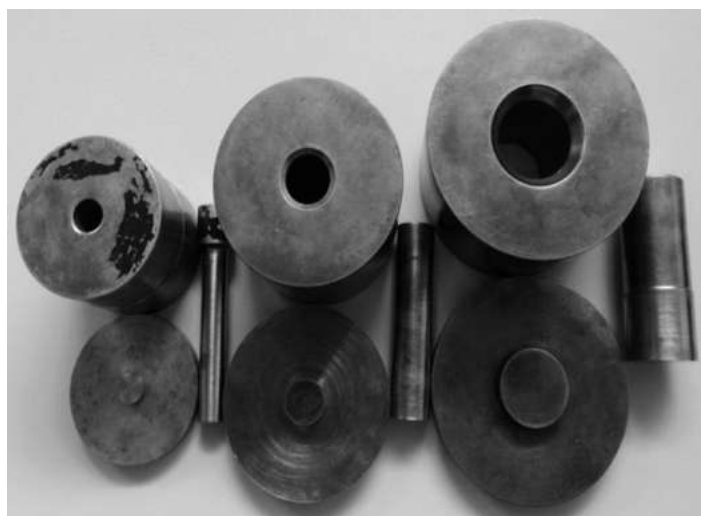
Figura 3- 2: Dado de diferentes diámetros 10, 15 and 25mm.
