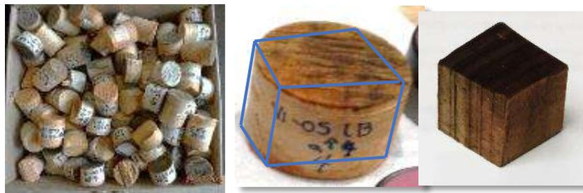
Figura 8. 1 Probetas de madera deteriorada empleadas
