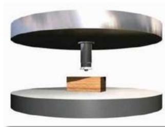
Figura 3. 14 Esquema de ensayo de dureza (puede medirse en forma normal o paralela a la fibra) (Salas, 2013)
