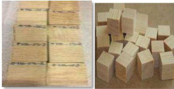
Figura 8. 2 Probetas de madera sana empleadas
