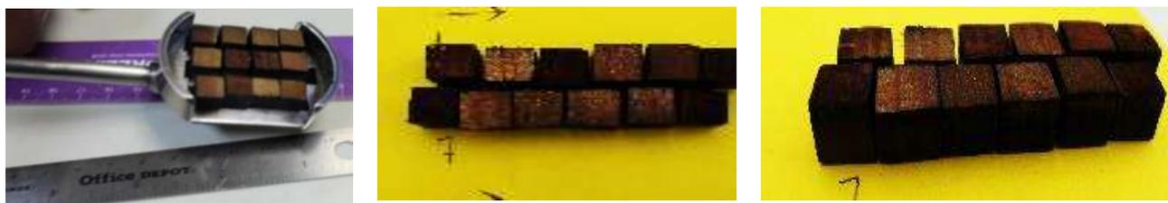
Figura 8. 14 Montura de aleación de Aluminio y muestras
