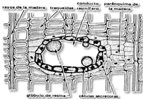
Figura 3. 8 Canal resinífero y elementos que conforman el tejido en coníferas (Barañaño, 2008)
