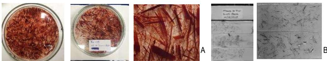
Figura 8. 23 (A) obtención de material disociado de las muestras, (B) material disociado con el tinte colocado en el cubreobjetos
