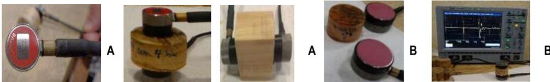
Figura 8. 12 (A) Transductores de onda longitudinal V103 frecuencia 1.0Mhz y (B)transductores de onda transversal: V151 frecuencia 0.5Mhz
