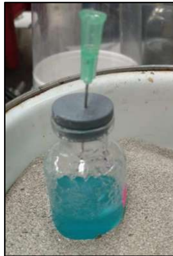
Figura 39. Reacción variando la concentración de la sal de cobre, donde no se observa cambio que evidencie la reducción de la sal.
