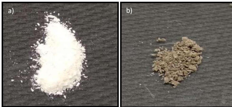
Figura 42. a) hojuelas de CTS puro y b) hojuelas de CTS soportando microcristales de \text{Cu}_2\text{O} .
