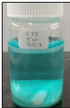
Figura 7. Apariencia de las hojuelas de CTS con altas concentraciones de \text{CuSO}_4 .
