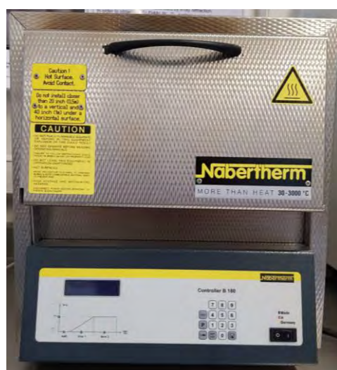
Figura 4.- Horno Nabartherm usado durante la calcinación de la doble perovskita.
