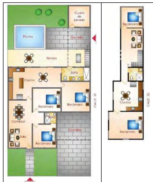
Figura 37. Vivienda en media unidad. Muestra de división predial, en la Colonia Miguel Alemán con Casa Vieja y Casa Nueva ubicada en esquina. Fuente: Trabajo de campo en 2006, Vivienda de la familia Flota Cabrera.
