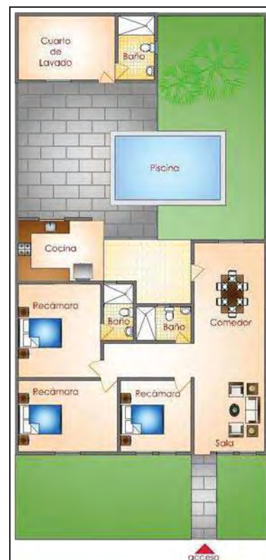
Figura 47. Vivienda con dos cuartos y cocina agregados en el área lateral
