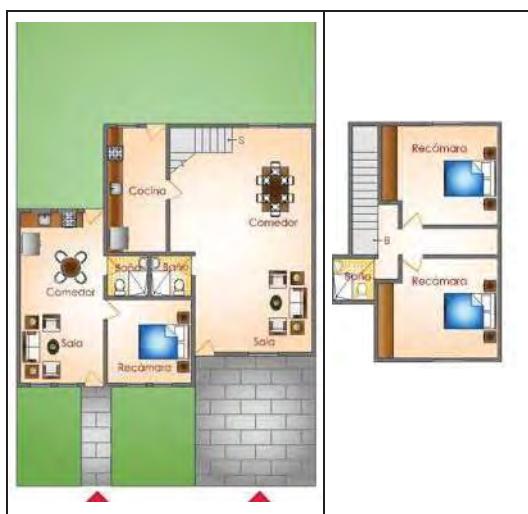
Figura 36. Vivienda con división predial, con agregados en el área lateral: sala comedor en planta baja y dos cuartos y baño en planta alta. Fuente: Trabajo de campo, 2006, vivienda de la familia Castro Morales.
