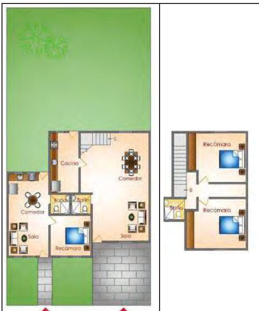
Figura 52. Vivienda con división predial, con agregados en el área lateral: sala comedor en planta baja y dos cuartos y baño en planta alta. Fuente: Trabajo de campo, 2006, vivienda de la familia Castro Morales.
