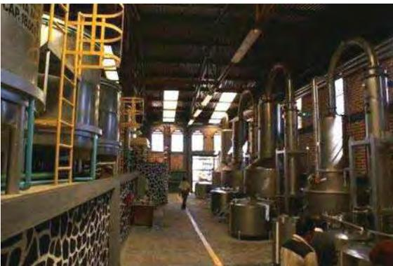
Imagen 203. El espacio destinado a los alambiques en la destilería industrial de La Cofradía en Tequila se ubica en la parte más baja de toda la instalación permitiendo que el mosto fluya por gravedad a través de cada etapa del proceso.
