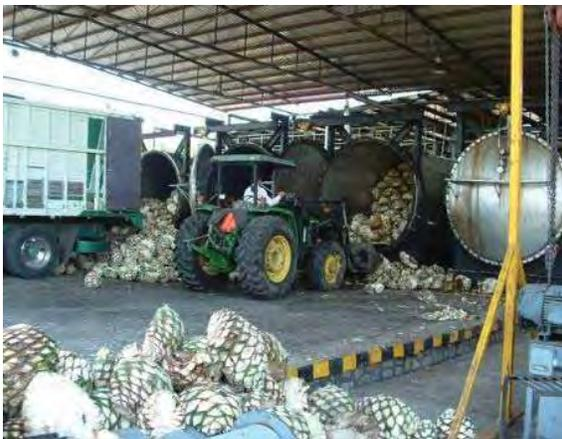
Imagen 80. Movimiento de las piñas de agave por medio de trascabos hacia los autoclaves de cocimiento en la destilería Rubio ubicada en las ajueras de Tequila.
