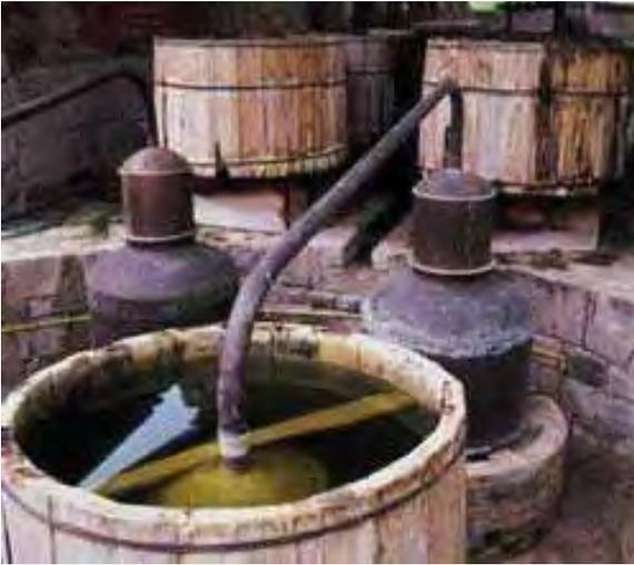
Imagen 185. Alambiques de raigambre árabe en una destilería ubicada en Matatlán Oaxaca, región que preserva una rica tradición en la elaboración del vino mezcal.
