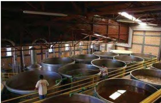
*Imagen 176. Tinas de fermentación ubicadas en un nivel más bajo del área de hornos para permitir el flujo por gravedad en la destilería La Cofradía en Tequila.*
