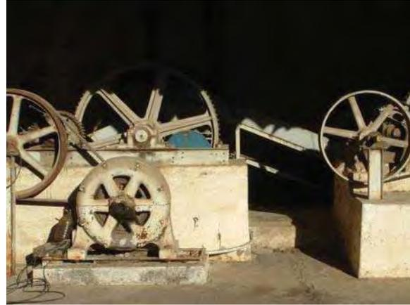
Imagen 80. Aspecto de los engranes y motores que mueven los cilindros de prensado.
