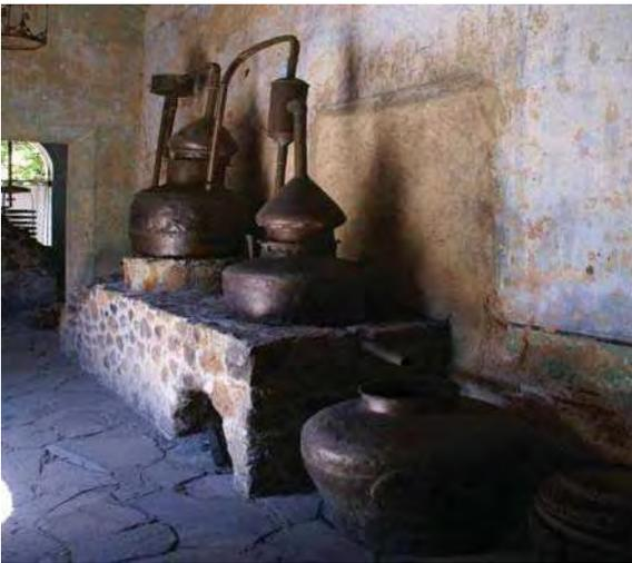
Imagen 220. Vista lateral del banco de alambiques en recreación de la taberna de José Cuervo en Tequila. En este caso se trata de una adaptación incipiente para, a través de dos alambiques realizar la destilación continua.
