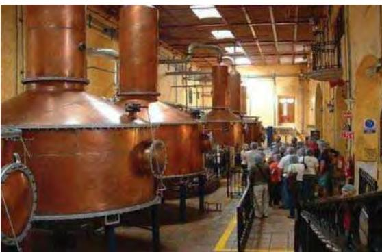
Imagen 222. Gran sala de destilación continua en La Rojeña con los enormes alambiques de cobre donde se calienta con vapor el mosto para facilitar la evaporación.
