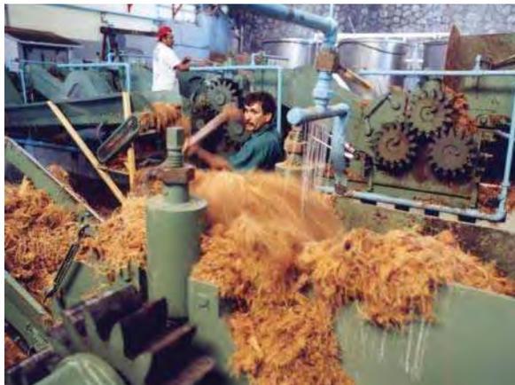
*Imagen 124. Trabajo de la molienda en el tándem mecánico de la fábrica el Llano en Tequila.*
