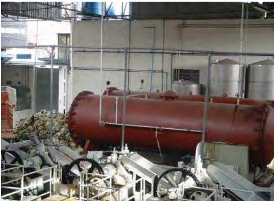
Imagen 78. Autoclaves para cocimiento de agave y tándem de molienda en la fábrica El Llano en Tequila.
