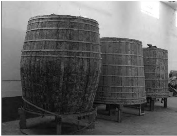
Imagen 37. Los recipientes de madera se popularizaron rápidamente por el nuevo mundo, era la principal forma en que se trasladaban y conservaban los líquidos de diversa índole hasta la popularización de los frascos de cristal. Cubas de madera para fermentar el mosto de mezcal. Destilería de la hacienda de La Providencia, El Arenal.
