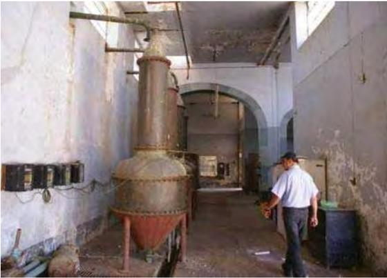
Imagen 83. Sala de alambiques de cuatro unidades para primera destilación y uno para segunda pasada. Los cuellos de cisne se comunican con los tanques de resfío localizados en la parte posterior.
