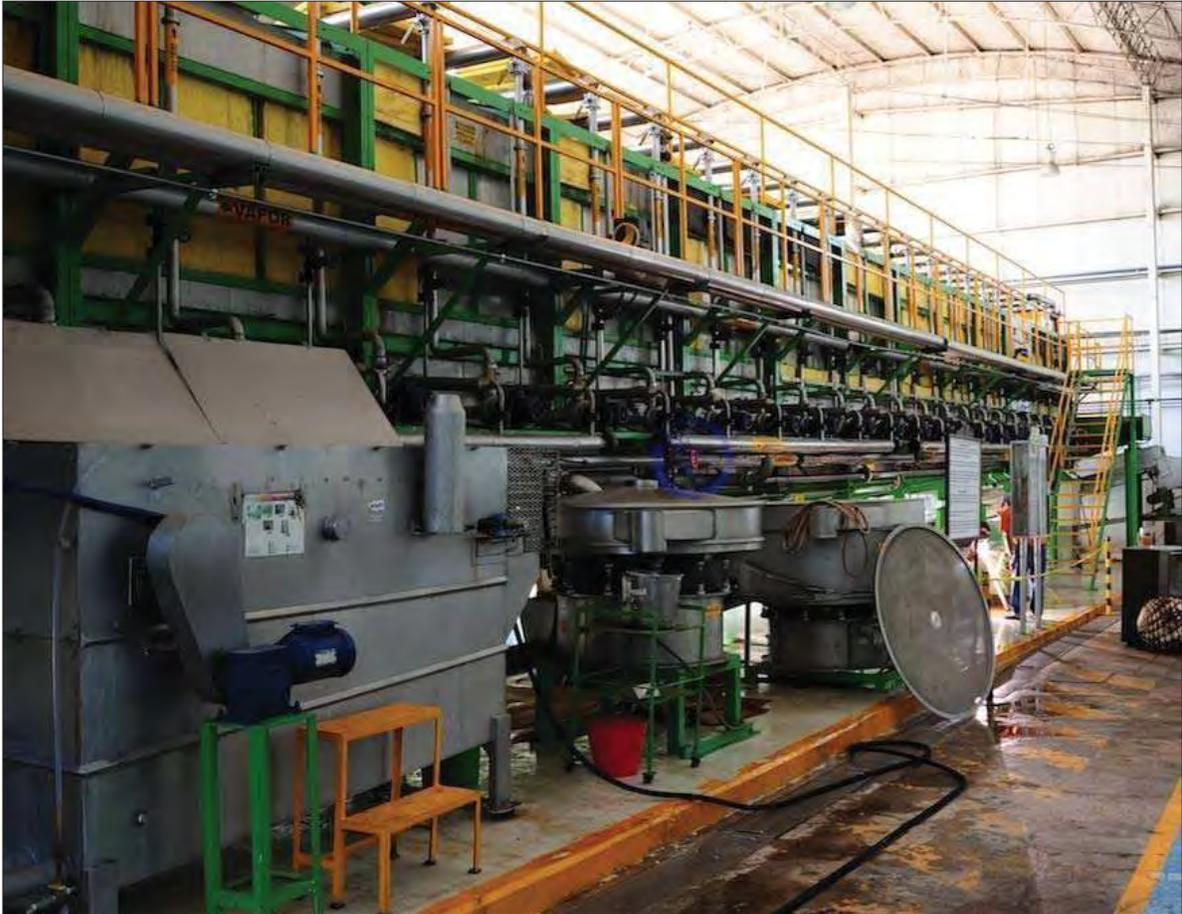
*Imagen 127. Difusor mecánico en la destilería de La Perseverancia.*
