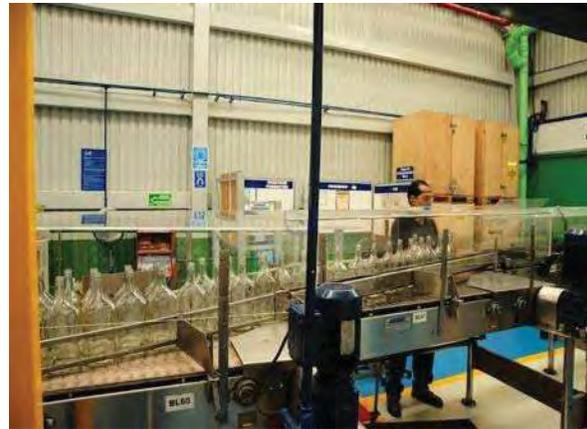
Imagen 240. Bandas para el embotellado mecánico en La Perseverancia en Tequila.
