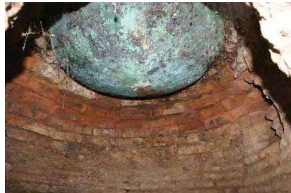
Imagen 47. Cazo de cobre inferior sobre el hogar. El calentamiento del mezcal por este sistema permitía la producción de vapor de agua para el cocimiento del mezcal.
