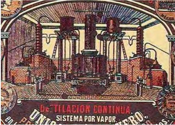
Imagen 215. Etiqueta del tequila Jesús Flores elaborado por José Cuervo a finales del siglo XIX en donde se muestra la amplia sala de destilación de La Constanca. La etiqueta hace referencia a los alambiques de destilación continúa calentados por vapor. Se puede apreciar en los extremos los alambiques para ordinario en un plano más bajo y en otro bloque contiguo la torre del alambique para segunda destilación que estaban interconectados para efectuar la destilación continua. Archivo Casa Cuervo.
