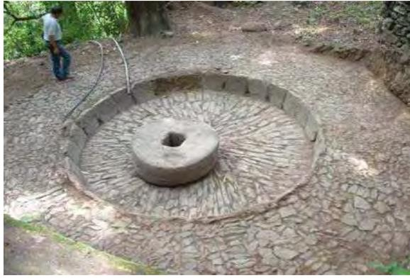
Imagen 106. Aspecto del espacio de molienda en La Miniatura de Amatitán está constituido por un amplio brocal de cantera labrada, un pavimento de rajuela para facilitar el machacado del mezcal con la gran muela de piedra. Al centro se ubica el eje metálico.
