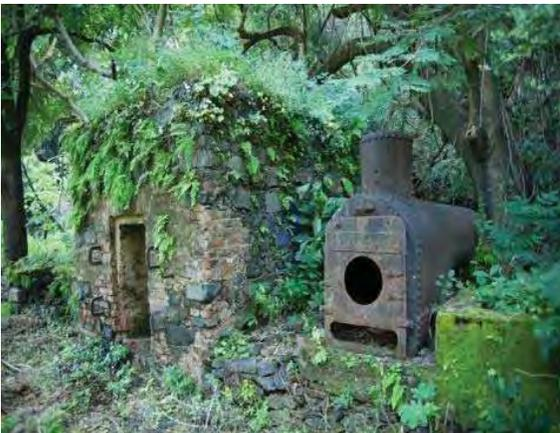
*Imagen 68. El cubo del horno de mampostería cubierto de helechos y a su costado, la caldera de fierro para producir vapor que se alimentaba con leña recogida de los alrededores. Estos componentes permiten fechar esta instalación hacia las últimas décadas del siglo XIX.*
