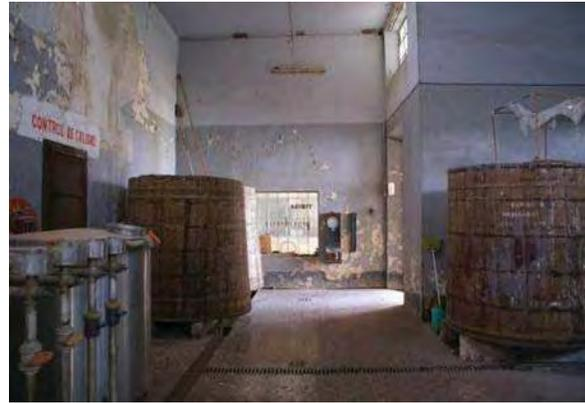
Imagen 84. Al fondo de la nave de destilación se ubican los tanques para guardar el “ordinario” en espera de la segunda destilación.
