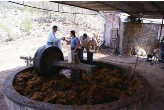
Imagen 113. La tabona de Atemánica en la barranca de Santiago, fue rehabilitada utilizando un molino previo.
