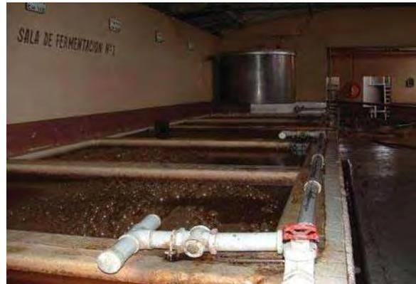
Imagen 169. Tinas de fermentación de mampostería en la destilería de El Cascabuín en El Arenal.
