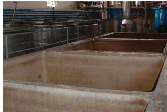
Imagen 167. Pilas de mampostería en la fábrica El Llano de Tequila.
