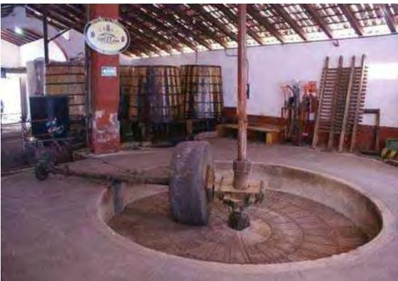
Imagen 115. Tabona de molienda de mezcal y al fondo los pipones de fermentación de madera en la destilería La Fortaleza de Tequila.
