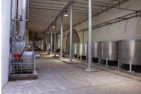
*Imagen 173. Espacio para fermentos en la destilería rural de Santa Rita. Inicialmente formado por pozas de fermentación y actualmente por tinas de acero.*
