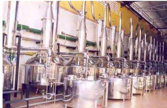
Imagen 202. Gran batería de alambique de acero inoxidable en la fábrica nueva de San José del Refugio en Amatitán. Son utilizados principalmente para la primera destilación
