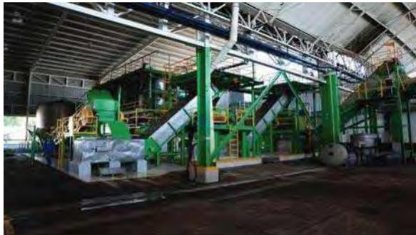
Imagen 126. Desgarradora mecánica para preparar la fibra cruda que entra al difusor en La Perseverancia.
