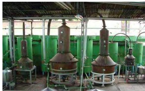
Imagen 223. Batería de alambiques en La Guarrreña para primera y segunda destilación interconectados para actuar de manera continua.
