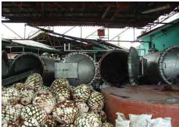
Imagen 79. Hornos de autoclave de acero para el cocimiento del agave en La Guarreña de Tequila.
