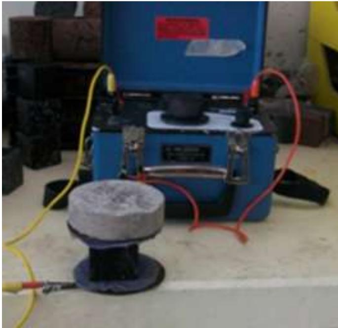
Figura 2.5: Equipo resistividad eléctrica marca Nilsson (propiedad del autor).
