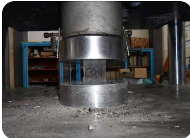
Figura 2.10: Esfuerzo a Compresión Uniaxial.
