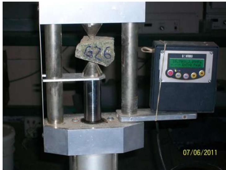
Figura 2.2: Aparato de carga puntual (propiedad del autor).
