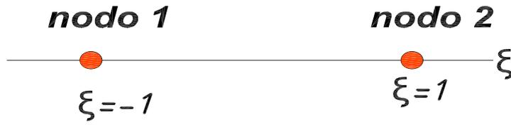
Figura 3.3: Elemento lineal en la coordenada natural.
