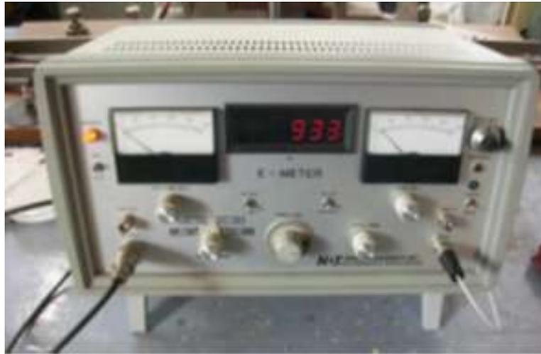
Figura 2.6: Equipo de frecuencia de resonancia (propiedad del autor).
