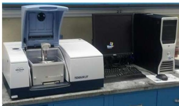
**Figura 28.** Equipo de espectroscopía infrarroja por transformada de Fourier.
