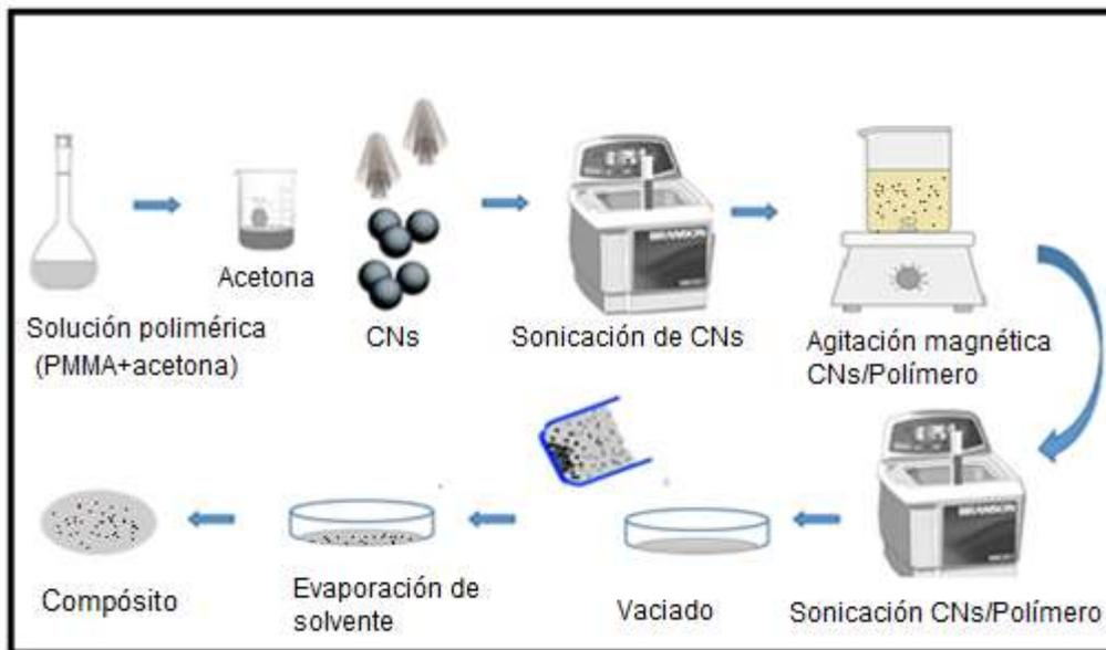
**Figura 24.** Método de mezclado en solución/sonicación usando acetona como disolvente para obtención de compósitos CNTs/PMMA y CSs/PMMA.
