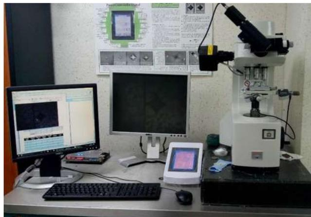
**Figura 29.** Microdurómetro Vickers Mitutoyo HM-120.
